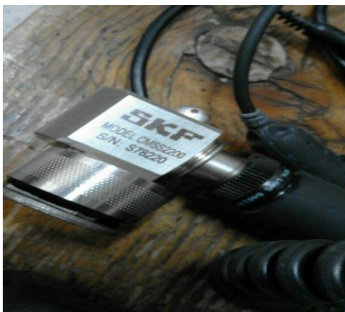
slika 14. Mjerna sonda SKF CMS2200
