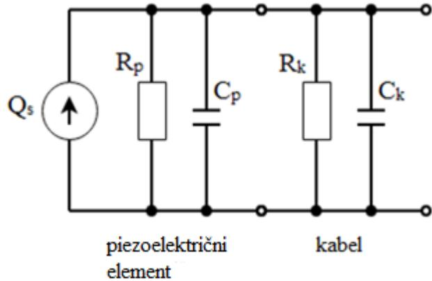
slika 10. Ekvivalentna shema piezoelektričnog elementa s kabelom
