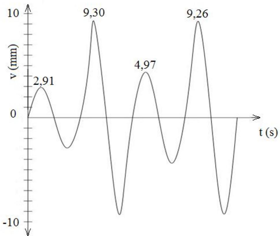
slika 25. Krivulja Av vrijednosti za mjerno mjesto CPV1-1H
