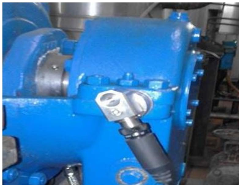
Slika 20. Ispravno postavljena mjerna sonda na mjerno mjesto CPV1-4H
