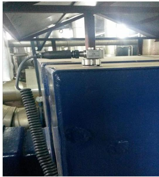
slika 22. Ispravno postavljena mjerna sonda na mjerno mjesto CPV1-1V
