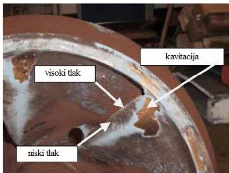
slika 8. Tipična kavitacijska oštećenja rotora centrifugalnih crpki
