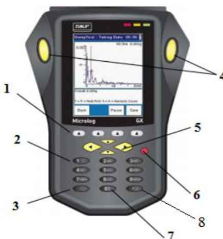
slika 15. Tipke i tipkovnica SKF Microlog GX uređaja
