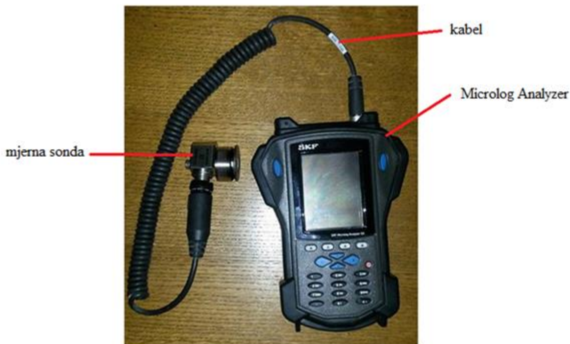
slika 13. Dijelovi SKF mjernog sustava
