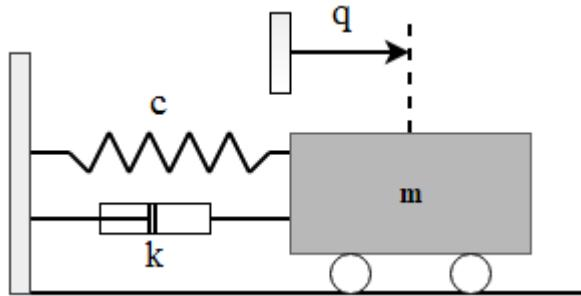
slika 3. Elastično-inercijski sustav s viskoznim prigušenjem
