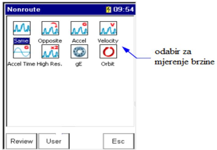
slika 18. Postavljanje mjerjenja brzine vibracija na SKF Microlog GX uređaju
