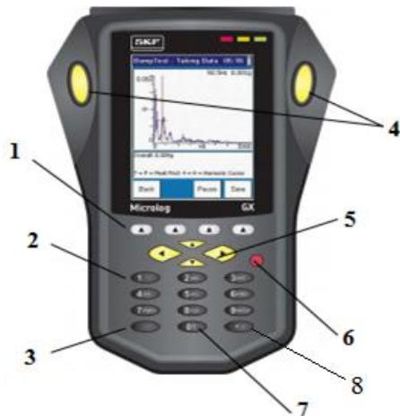
slika 15. Tipke i tipkovnica SKF Microlog GX uređaja
