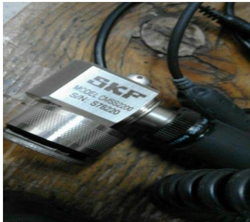
slika 14. Mjerna sonda SKF CMS220
