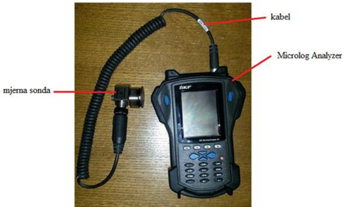
slika 13. Dijelovi SKF mjernog sustava
