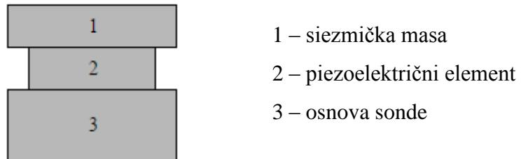
slika 9. Dijelovi piezoelektrične sonde
