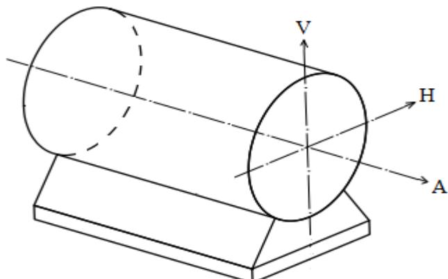
slika 16. Prikaz tri smjera za mjerjenje brzine vibracija na crpkama
