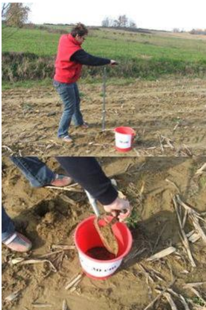
Slika 1. Uzimanje uzoraka sondom ( http://www.savjetodavna.hr/savjeti/13/173/kada-i-kako-ispravno-uzeti-uzorak-tla-za-analizu/ )
