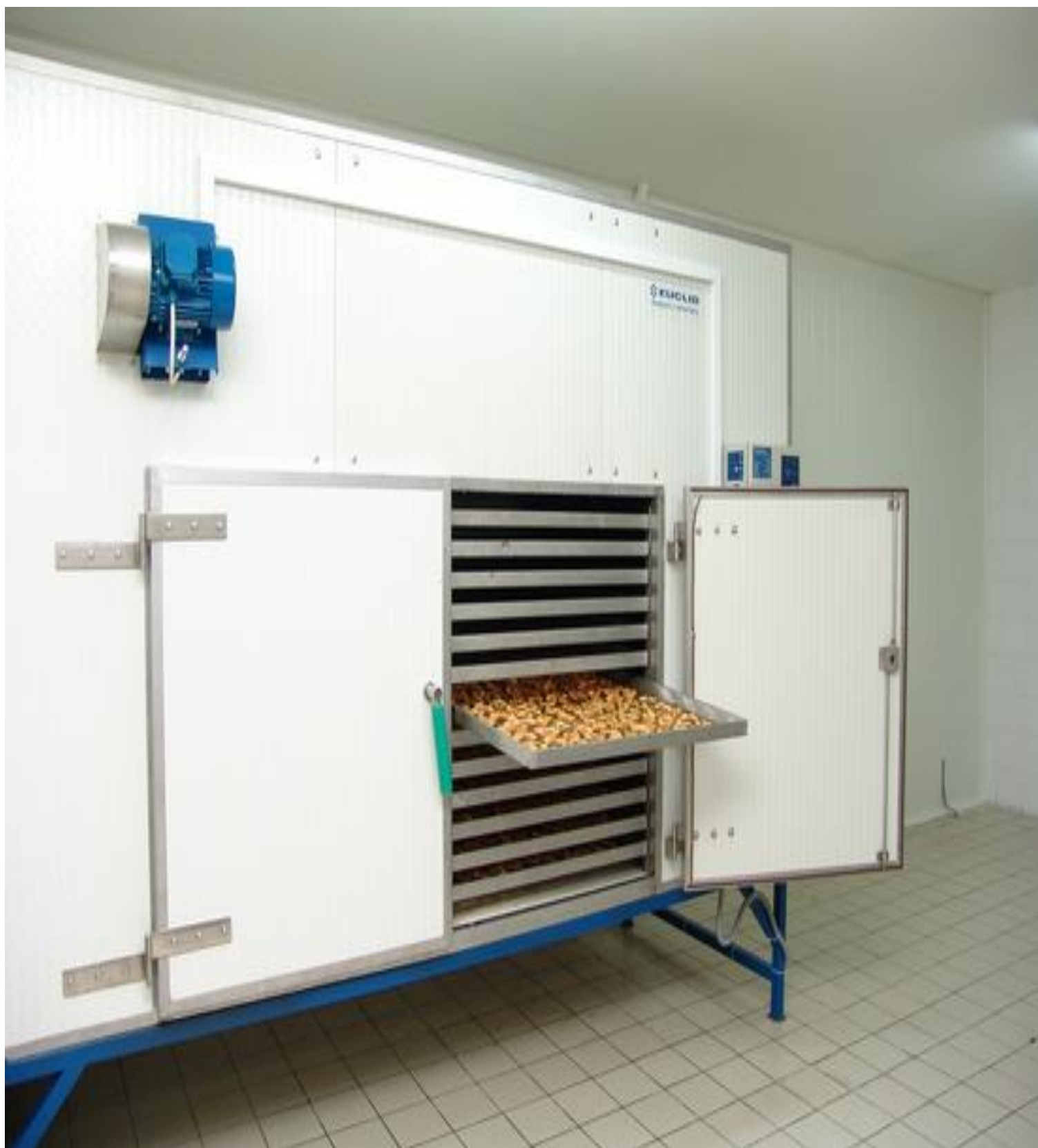
Slika 4. Komorna sušara za voće, povrće i ljekovito bilje EUCLID tip KSVP 20
