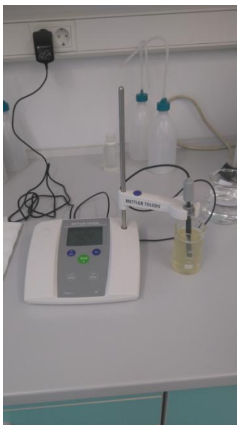
Slika 32. Mjerenje pH meda
