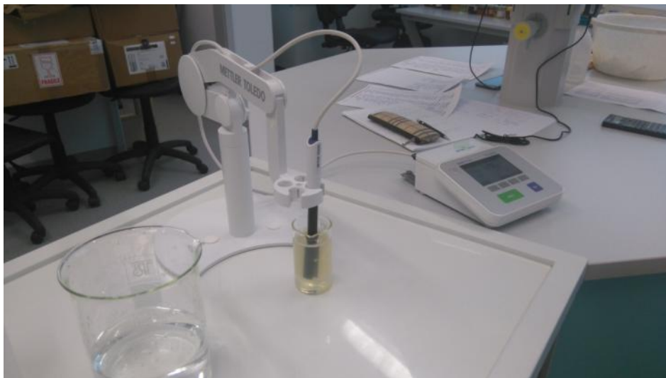
Slika 31. Mjerenje električne vodljivosti
