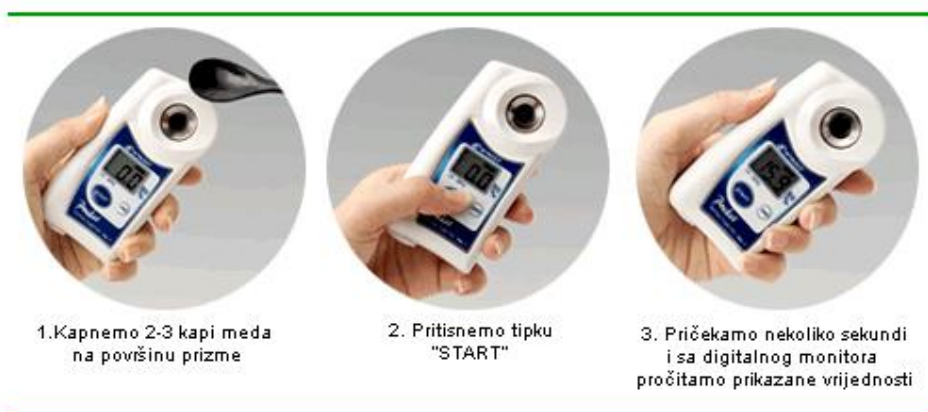
Slika 28. Mjerenje udjela vode u medu
