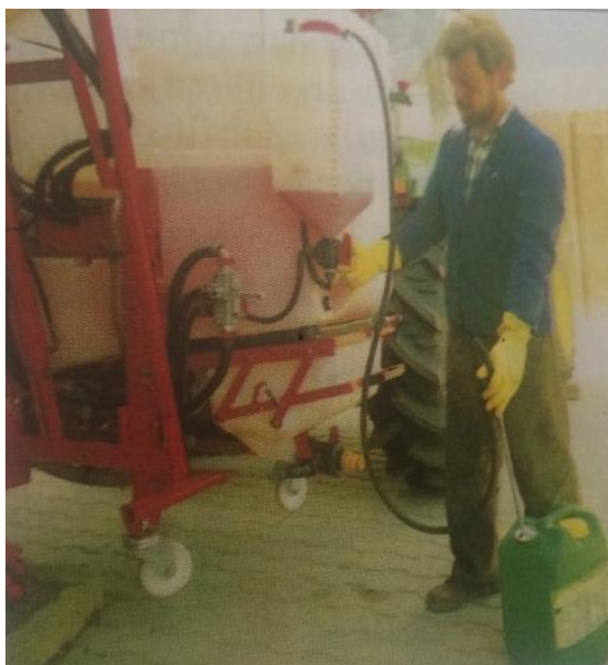
Slika 9. Spremnik za čistu vodu za pranje ruku i ambalaže
