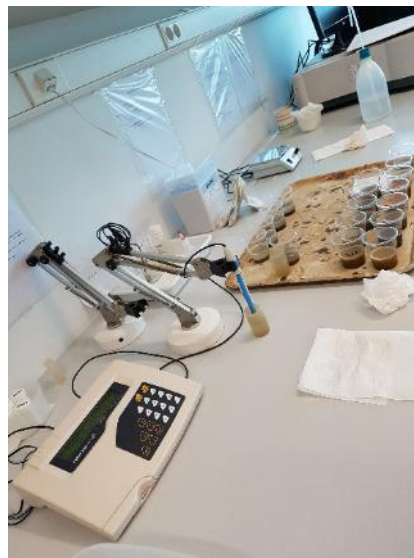
Slika 2. Mjerenje reakcije tla pomoću pH-metra (Izvor: Prpić, D.)
