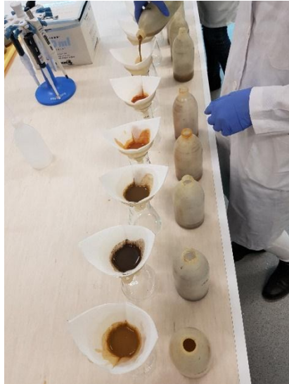
Slika 7. Filtriranje otopine kroz filter papir
