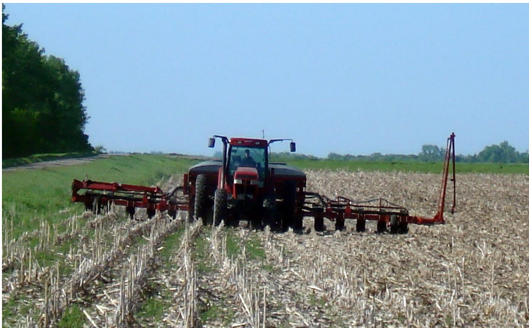
Slika 3. No-till (direktna sjetva bez obrade tla)
