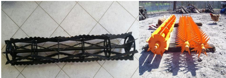
Slika 12. Prikaz a) rebrastog valjaka sjetvospremača i b) zvjezdastog i letvičastog valjka sjetvospremača (Izvor slike: http://poljoprivredni-forum.com/showthread.php?t=26475&page=9 )
