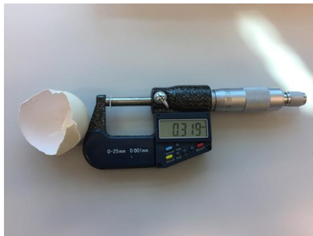
Slika 12. Mjerenje debljine ljuske jajeta
