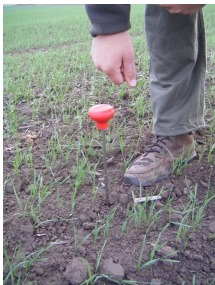
Slika 12. Štapna sonda tvorničke izrade (Jug i sur., 2015.)
