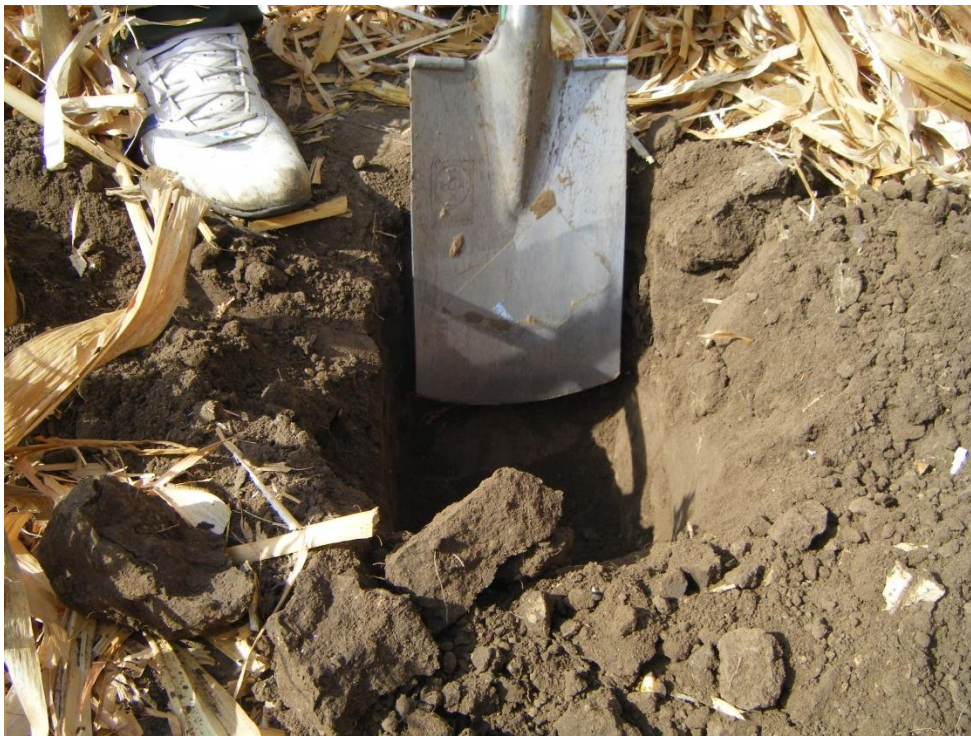
Slika 14. Utvrđivanje zbijenosti tla štihačom (Jug i sur., 2015.)
