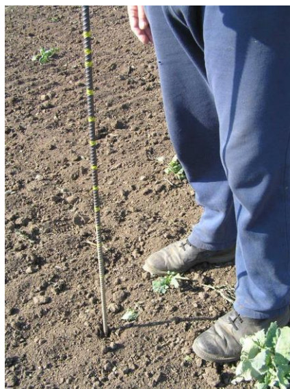
Slika 13. Štapna sonda izrađena u kućnoj radinosti (Jug i sur., 2015.)
