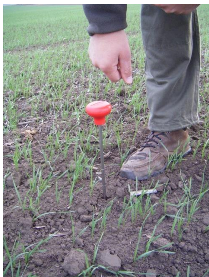
Slika 12. Štapna sonda tvorničke izrade (Jug i sur., 2015.)
