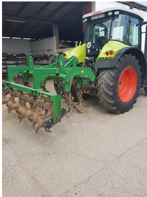
Slika 2. Podrivač za dubinsko rahljenje tla (izvor: autor, Ante Alduk)
