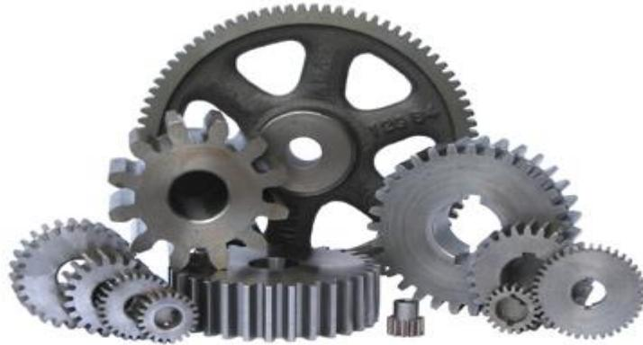
Slika 15. Zupčanici napravljeni lijevanjem sivog lijeva u kalupe
