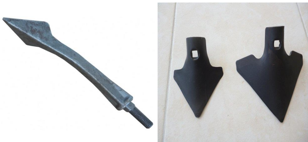
Slika 19. Klin drljače (lijevo) i motičica kultivatora (desno)
