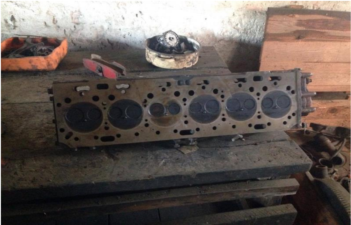
Slika 4. Glava motora za kombajn ili traktor
