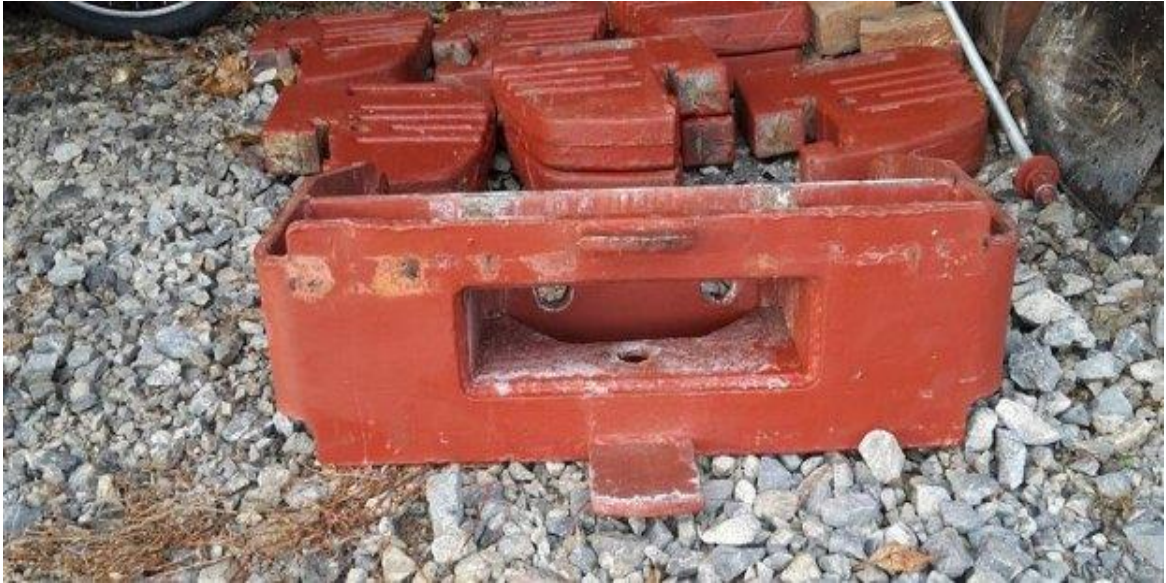
Slika 6. Utezi i nosači za traktor
