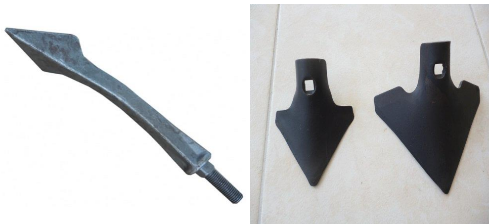
Slika 19. Klin drljače (lijevo) i motičica kultivatora (desno)
