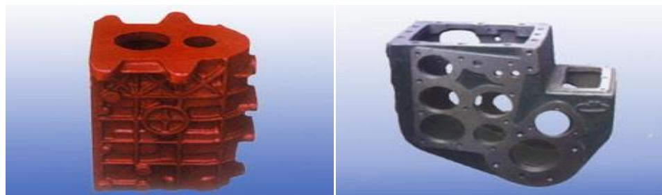
Slika 18. Traktorske mjenjačke kutije od sivog lijeva
