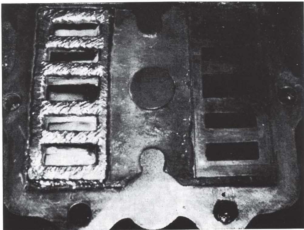
Slika 12. Zavarivanje izvedeno REL postupkom na hladno s elektrodom UTP8.
