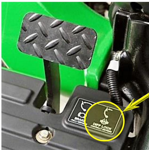
Slika 15. Papučica za zaključavanje diferencijala traktora „John Deere“
