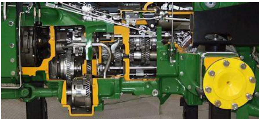
Slika 6. Mjenjač brzina poljoprivrednoga traktora
