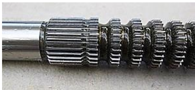
Slika 31. Alat za izradu unutarnjeg ozubljenja provlačenjem (Izvor: https://sh.wikipedia.org/wiki/Strojna_obrada#/media/File:Raeumnadel-letzte_Zahnreihen.JPG )
