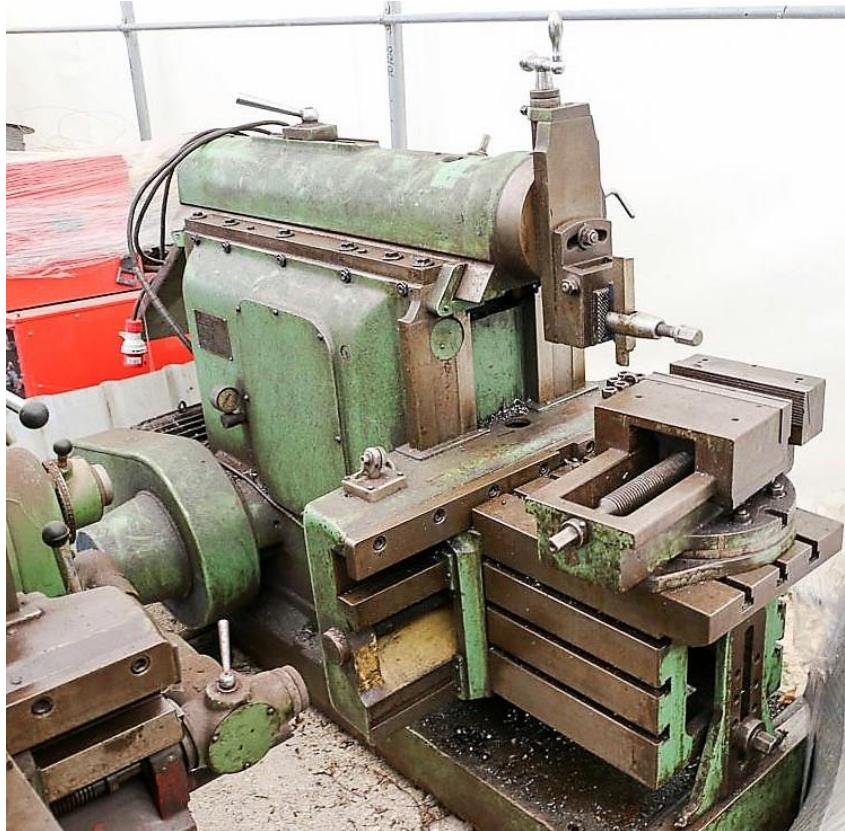
Slika 28. Kratkohodna blanjalica (Izvor: http://web-trgovina.metal-kovis.hr/slike/velike/blanjalica-hidraulicna-hod-700-mm-C-145_1.jpg )
