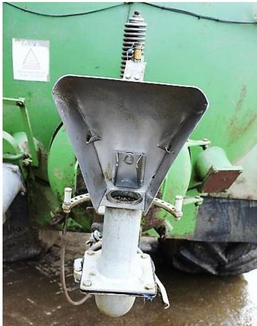
Slika 5. Raspršivač gnojovke od nehrđajućeg čelika
