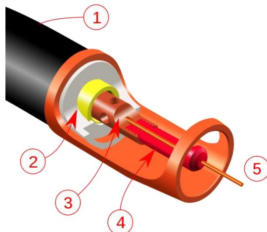
Slika 14. Pištolj za zavarivanje MIG/MAG postupkom
