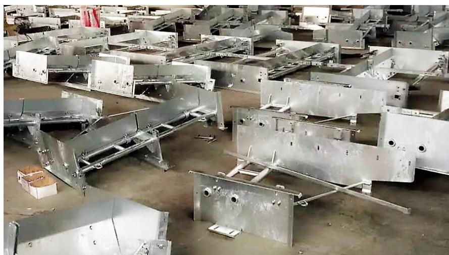
Slika 30. Nehrđajući dijelovi sustava za uklanjanje gnoja na svinjogojskim farmama
