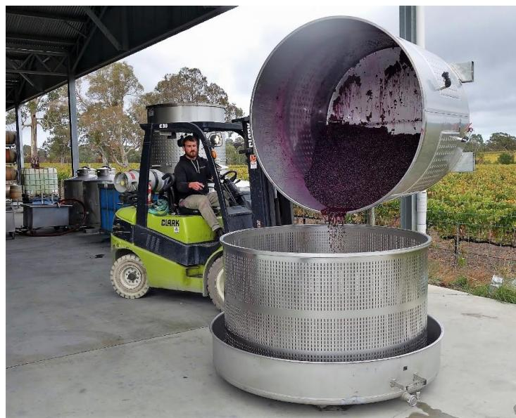
Slika 12. Nehrđajući spremnik i cjedilo za grožđe
