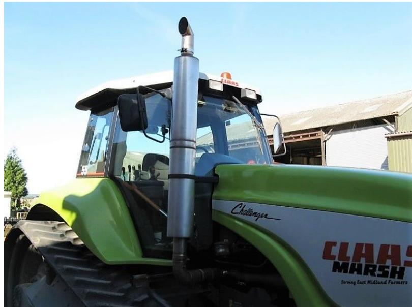
Slika 3. Ispušna cijev na traktoru (Izvor: [http://www.eurotrackltd.com/
