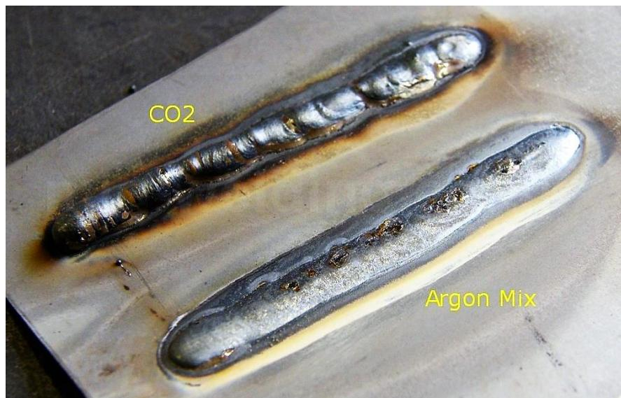
Slika 16. Usporedba izgleda zavara dobivenih MIG i MAG postupkom
