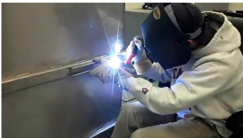
Slika 24. Popravak rashladne komore za mlijeko od nehrđajućeg čelika
