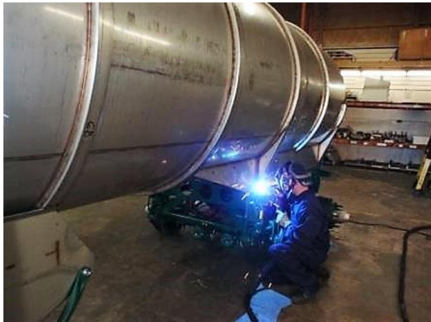
Slika 29. Popravak nehrđajućeg spremnika za gnojovku
