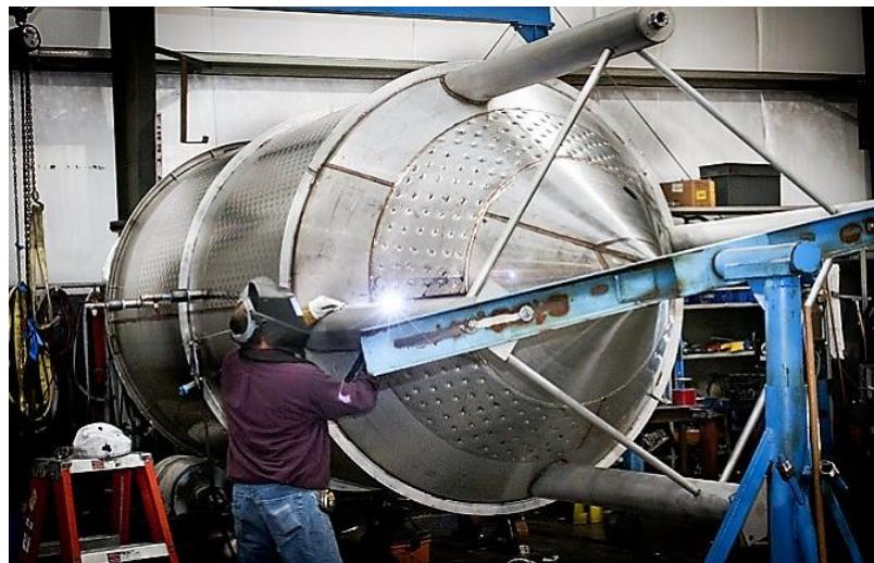
Slika 25. Popravak nehrđajućeg spremnika hrane za stoku
