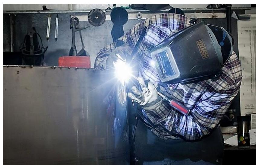
Slika 28. Popravak nehrđajuće posude u proizvodnji vina
