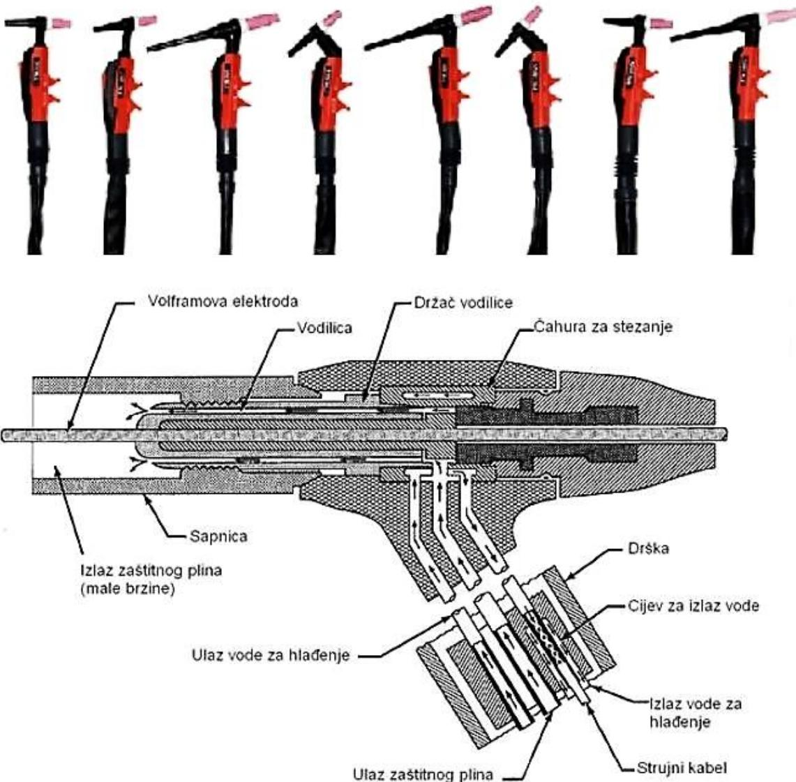
Slika 21. Vrste TIG pištolja za zavarivanje i shema pištolja s vodenim hlađenjem
