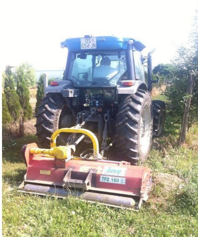
Slika 7. Malčer VOGER model TFZ 160 (vlastita fotografija)
