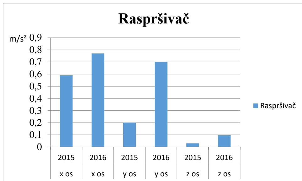
Grafikon 1. Srednje vrijednosti izmjerena vibracija prilikom rada raspršivača za 2015. godinu i 2016. godinu
