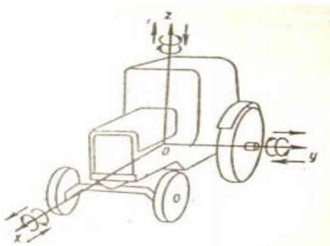
Slika 2. Rotacijske i translacijske vibracije traktora u koordinatnim osima
