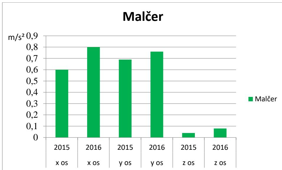
Grafikon 2. Usporedba srednjih vrijednosti mjerena vibracija koje se prenose sa upravljača traktora na sustav ruka - šaka rukovatelja pri radu raspršivača i malčera
