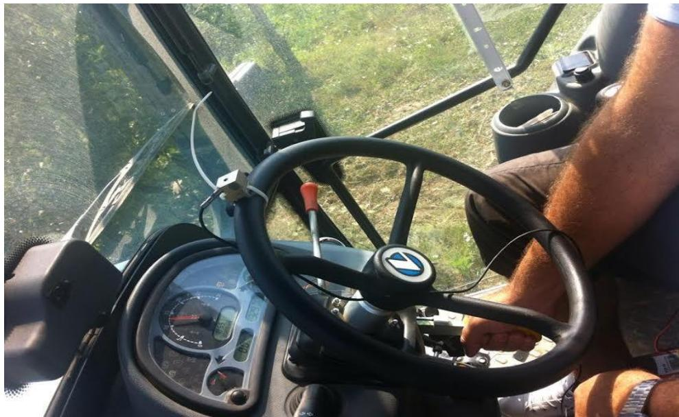
Slika 8. Senzor uređaja za mjerjenje razine vibracija (vlastita fotografija)
