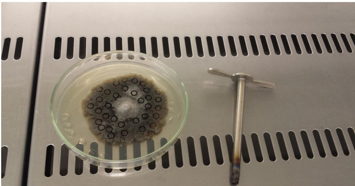
Slika 11. Kružni metalni rezač (Foto: Luka Vranješ)
