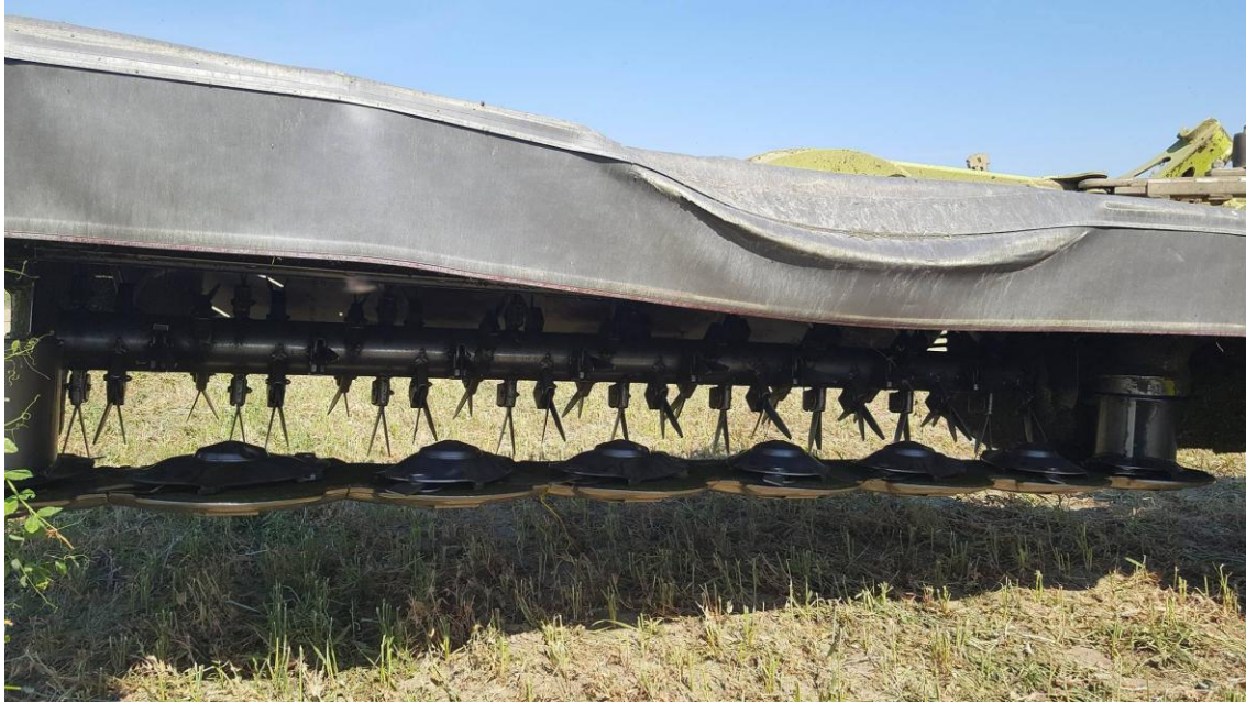
Slika 8. Izgled radnih organa kosilice „Claas 3200 FC DISCO“ (Izvor: vlastita fotografija)
