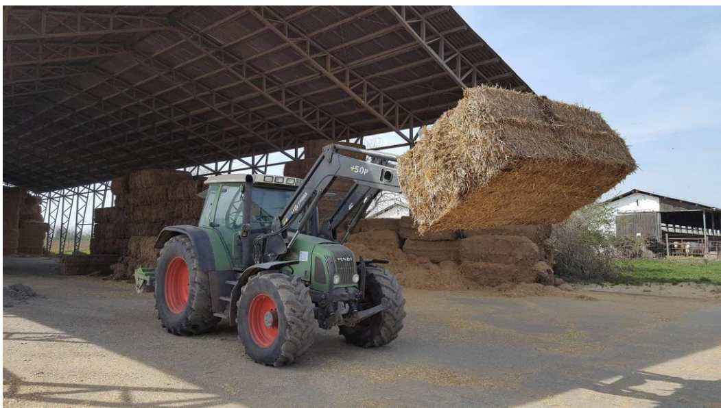
Slika 26. Primjer transporta prednjim traktorskim utovarivačem na farmi
