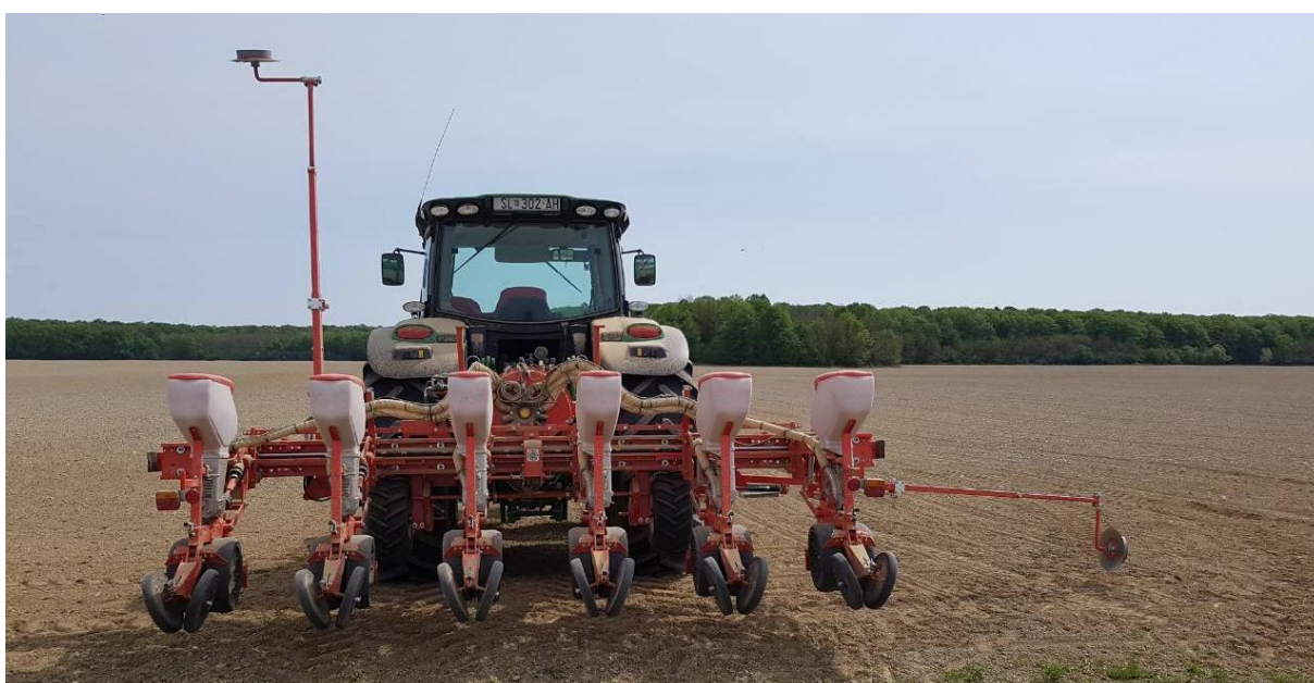
Slika 6 . Sijačica „Gaspardo Magica 6“ (Izvor- vlastita fotografija)
