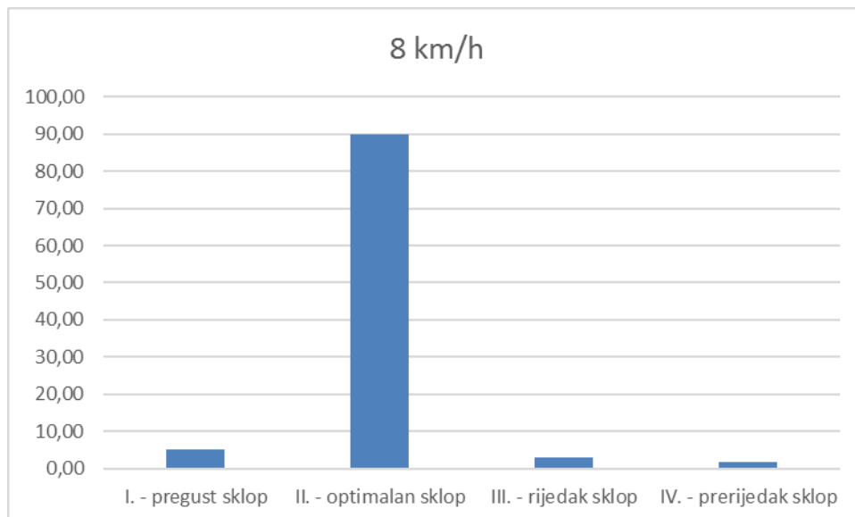
Grafikon 10. Postotni udio ostvarenih razmaka sjetve u redu u pojedinim skupinama razmaka sjetve pri brzini 8 km/h ( Izvor: vlastita izrada)
