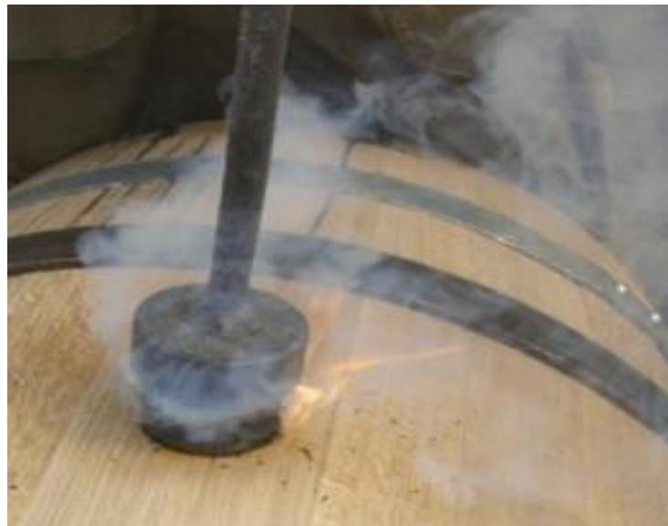
Slika 7: Sumporenje drvene bačve sumpornom trakom
