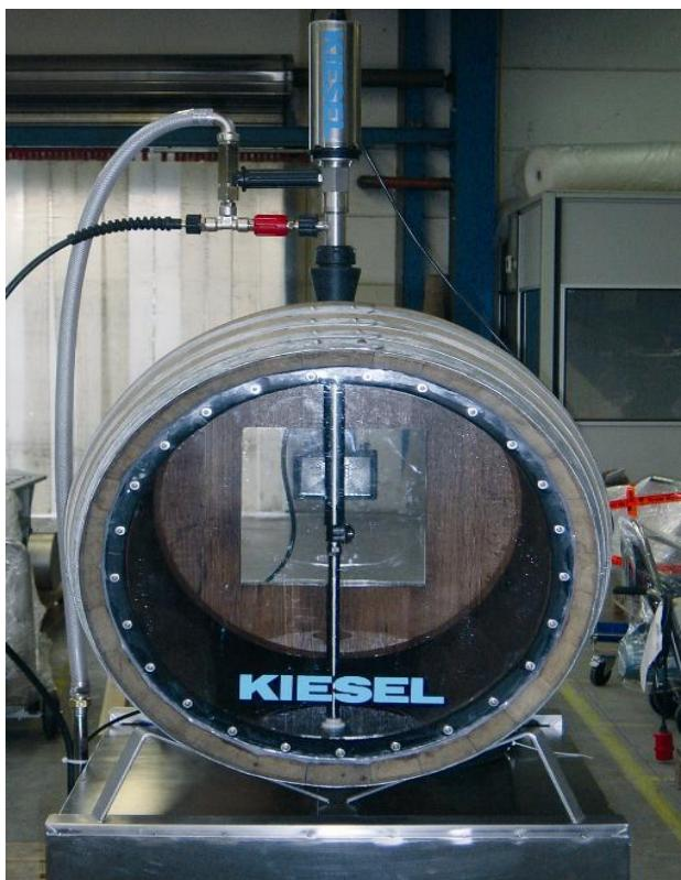
Slika 8: Perač drvenih bačava Njemačke tvrtke Kiesel
