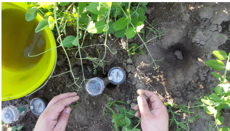
Slika 3. Tenziometri postavljeni u tlo
