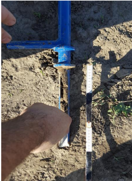
Slika 6. Uzorkovanje tla s određenih dubina
