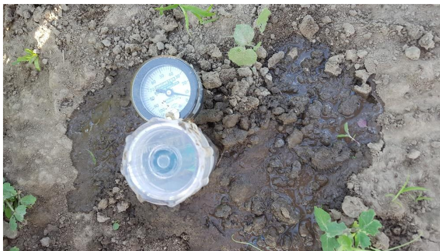
Slika 4. Tenziometar postavljen u tlo
