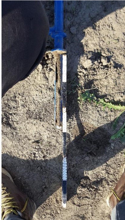
Slika 2. Određivanje dubine za uzrokovanje tla
