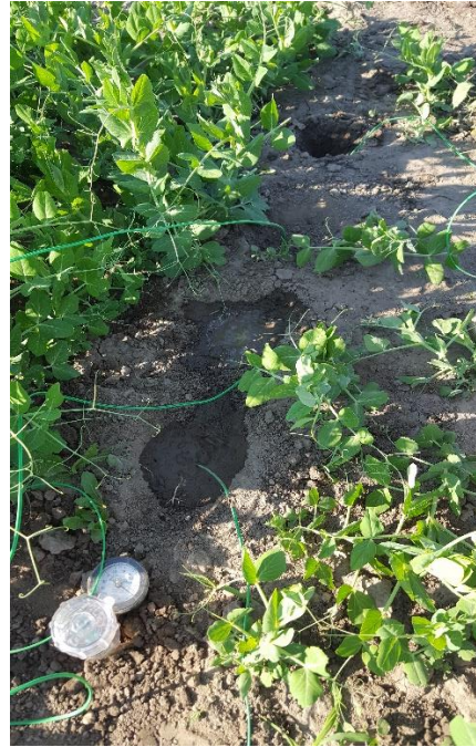
Slika 6. Tenziometar i Watermark uređaji postavljeni u tlo
