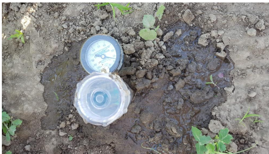
Slika 4. Tenziometar postavljen u tlo
