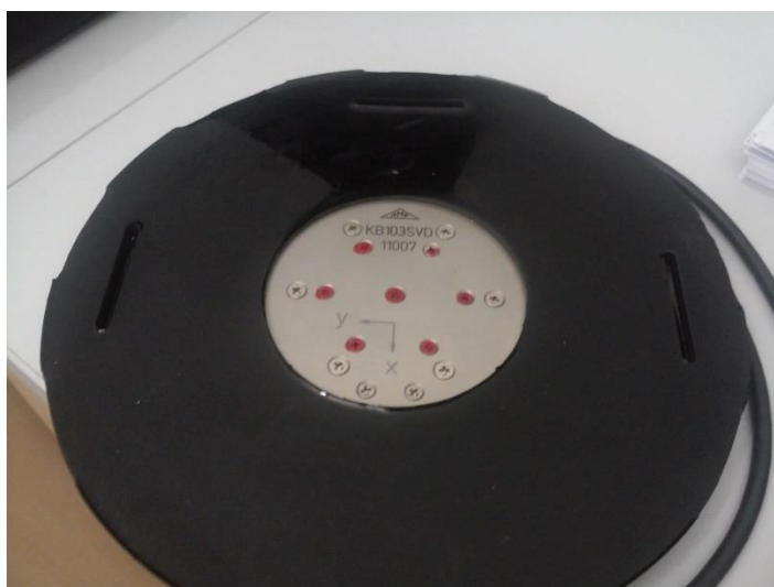
Slika 11. Prikaz pravaca mjerenja (vlastita fotografija)
