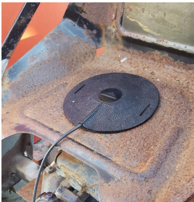
Slika 10. Prikaz postavljanja mjernog uređaja na sjedalicu (vlastita fotografija)
