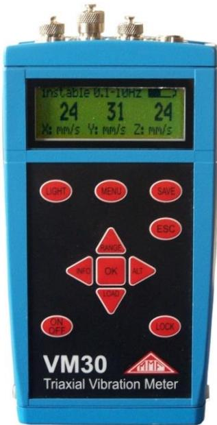
Slika 15. Uređaj za mjerjenje vibracija MMF VM30 (URL11)
