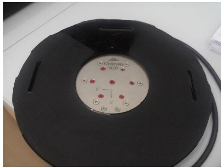
Slika 11. Prikaz pravaca mjerena (vlastita fotografija)
