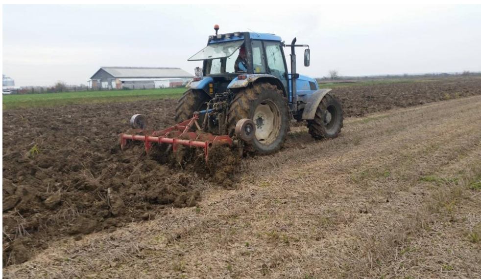
Slika 2. Duboka obrada tla podrivačem (foto: Ivan Goreta)
