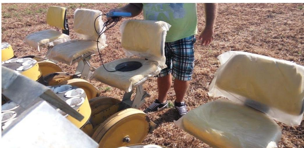
Slika 6. Uređaj za mjerjenje razine vibracija
