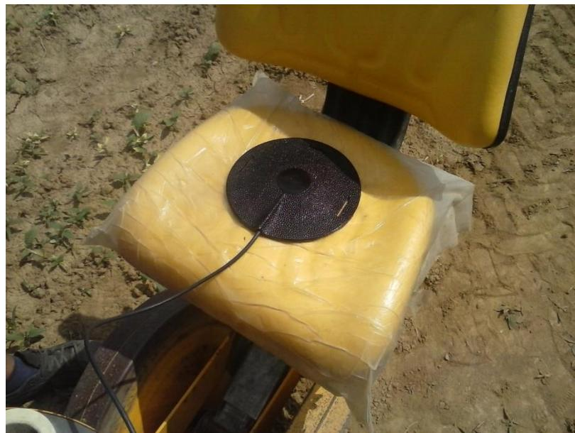
Slika 12. Podloga uređaja za mjerjenja vibracija
