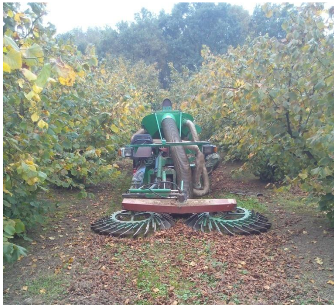
Slika 17. Samohodni stroj za skupljanje lješnjaka „Facma“
