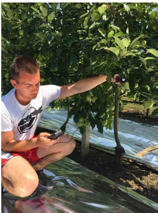
Slika 10. Mjerenje refleksije svjetlosti Lux metrom (autor: Đurković, 2015.)
