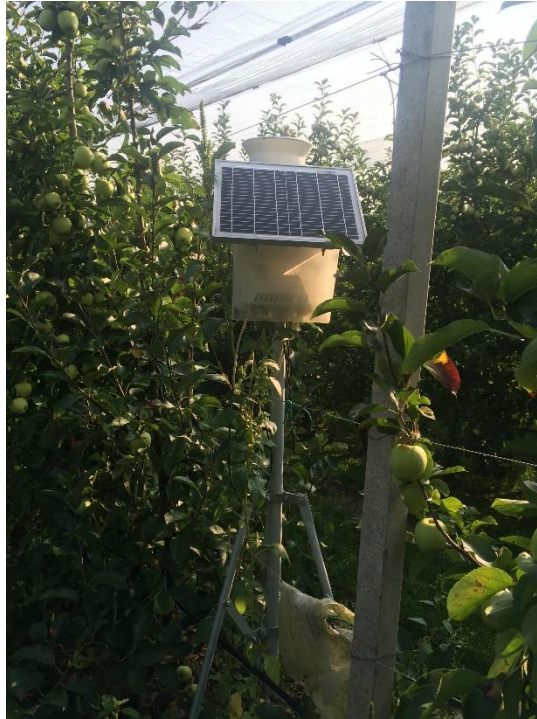
Slika 7. Agrometeorološka stanica (autor: Đurković, 2016.)
