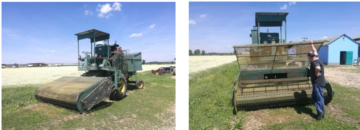
Slika 4. Samohodni berač kamilice (detaljan prikaz) ( Foto original )
