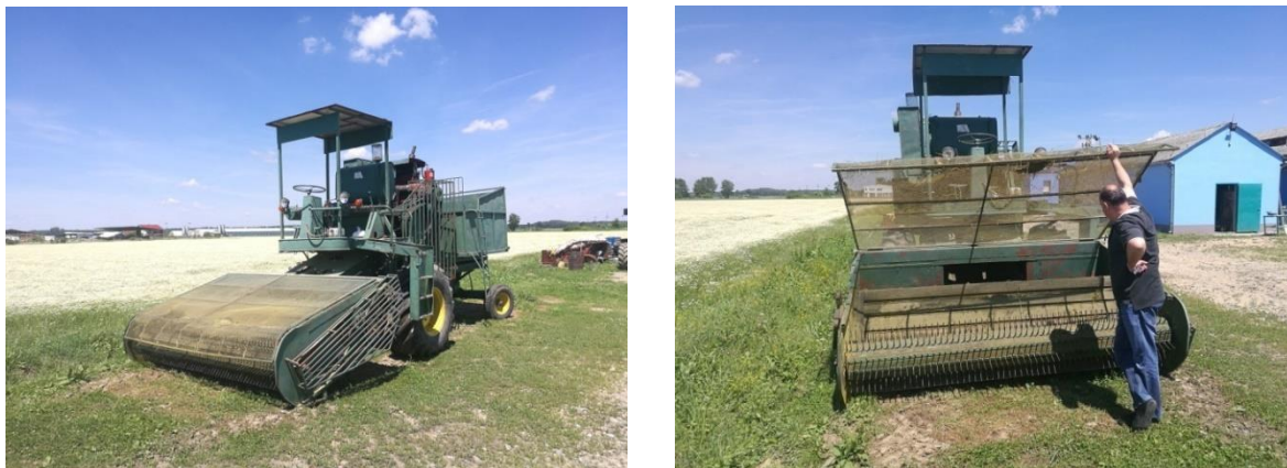
Slika 4. Samohodni berač kamilice (detaljan prikaz) ( Foto original )
