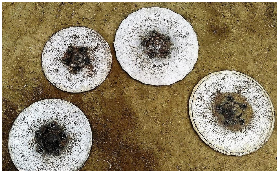
Slika 34. Demontirani istrošeni diskovi tanjurače
