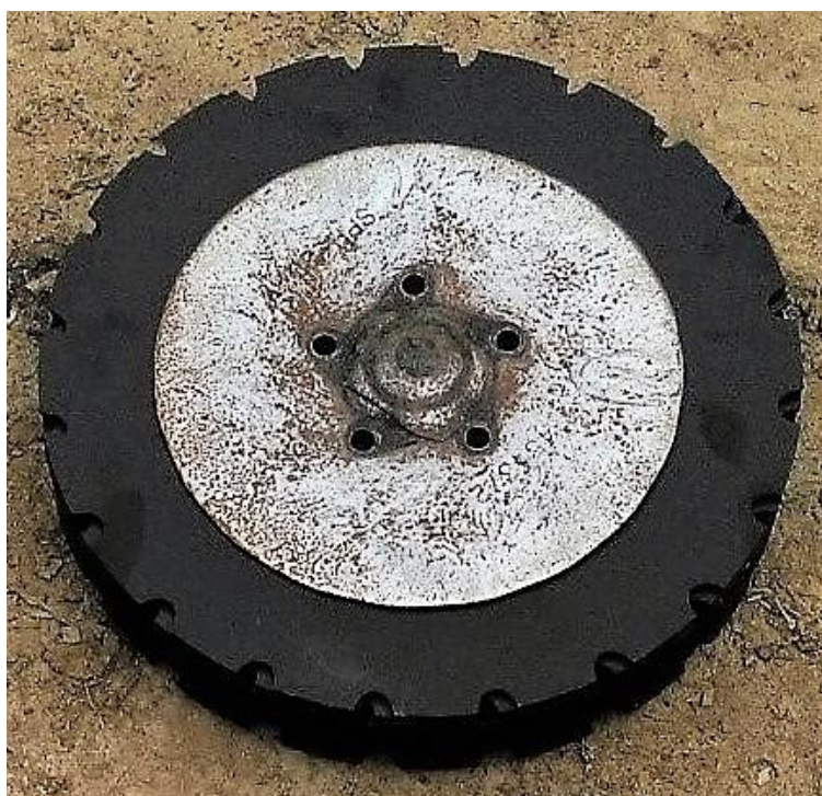
Slika 37. Usporedba promjera istrošenog i novog diska tanjurače
