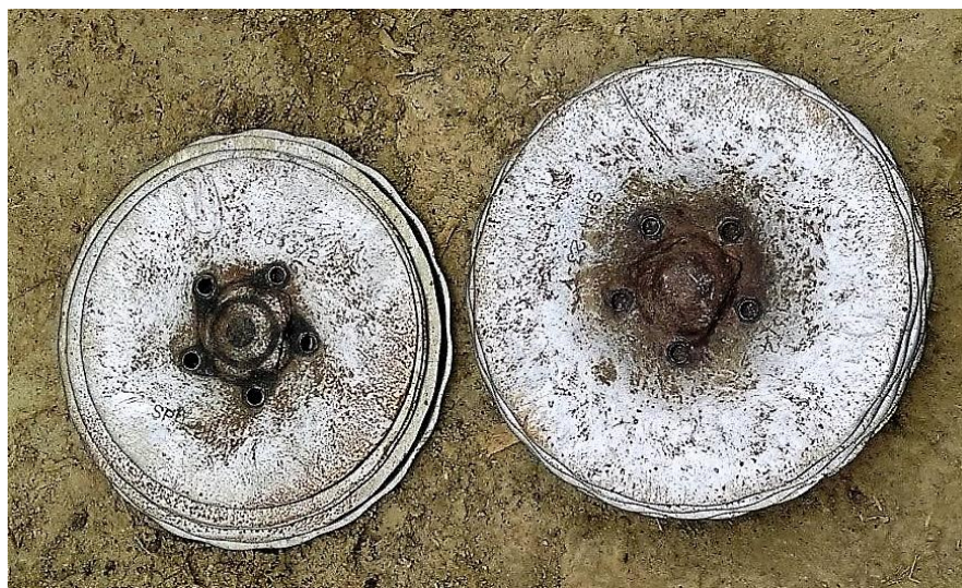
Slika 35. Usporedba istrošenosti diskova tanjurače
