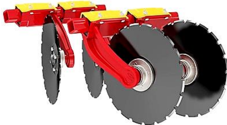
Slika 30. Segment tanjurače prednjih alata sijačice Rapid 400C
