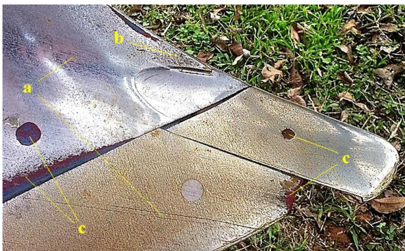
Slika 10. Tragovi trošenja alata za obradu tla (lemeš, crtalo i odgrnjača)
