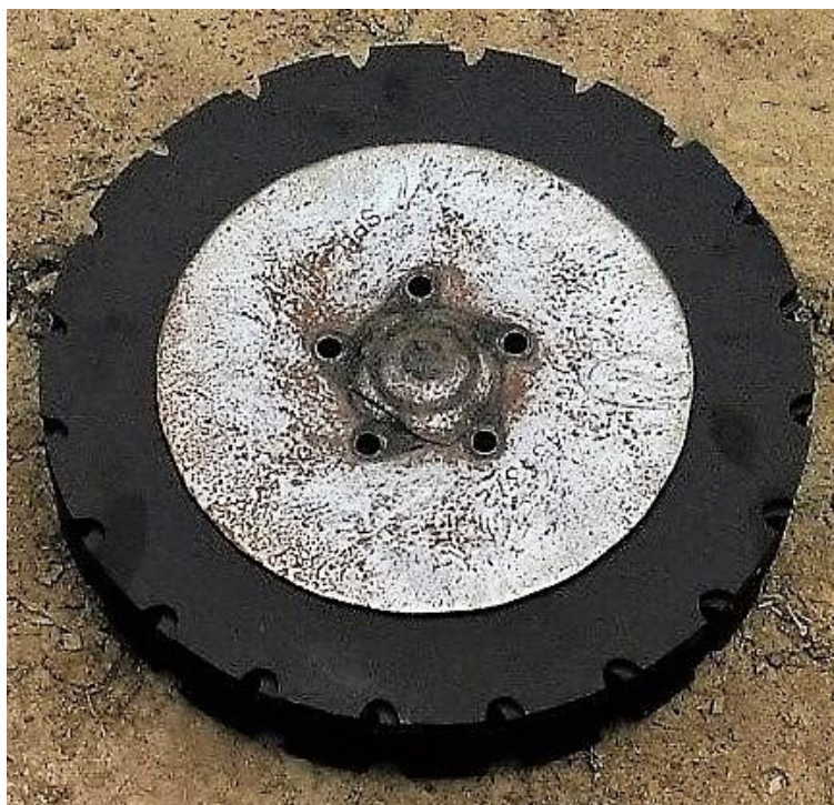
Slika 37. Usporedba promjera istrošenog i novog diska tanjurače
