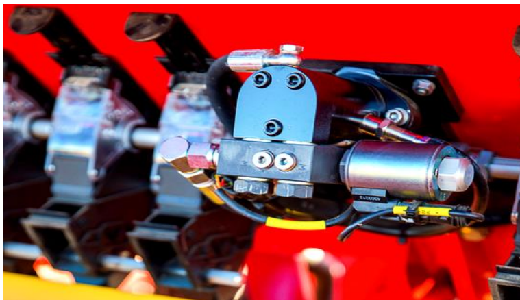
Slika 22. Sustav za hidrauličko mjerenje na sijačici Rapid 400C
