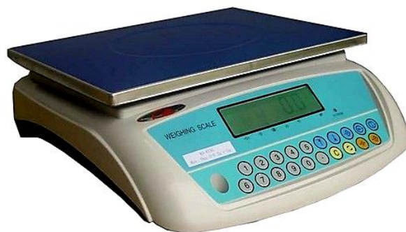
Slika 32. Digitalna vaga za vaganje masa diskova
