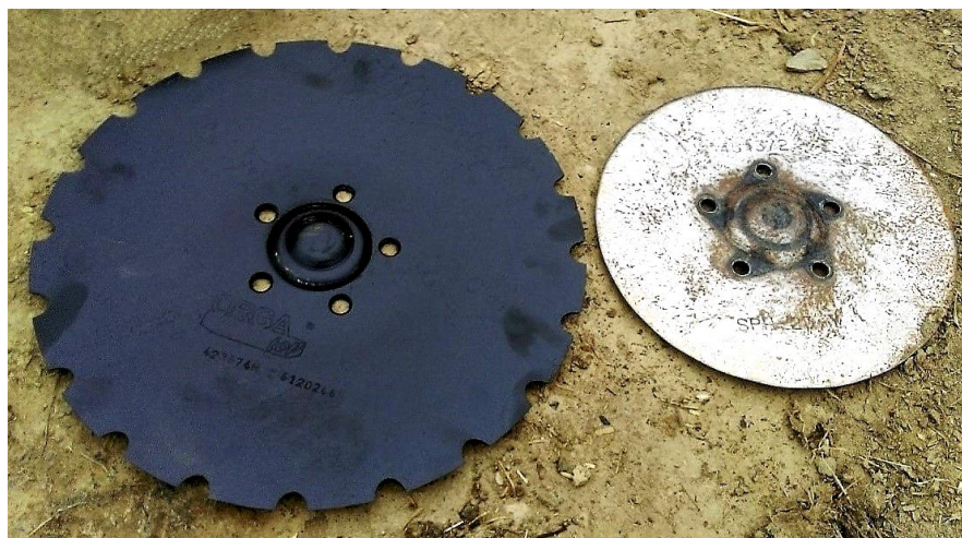
Slika 36. Usporedba novog i istrošenog diska tanjurače
