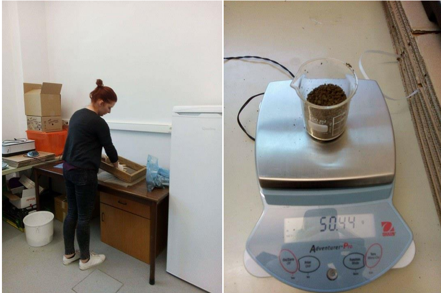
Slike 19. i 20. Prosijavanje uzorka tla i vaganje Foto: Ivana Greganić
