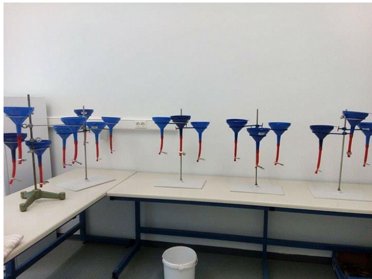
Slika 18. Baermanova metoda lijevka
