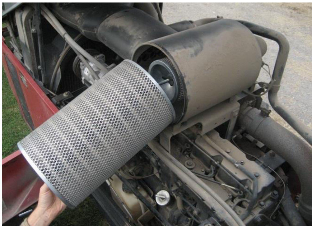
Slika 5: Suhi pročistač zraka (Izvor: Raić D.)
