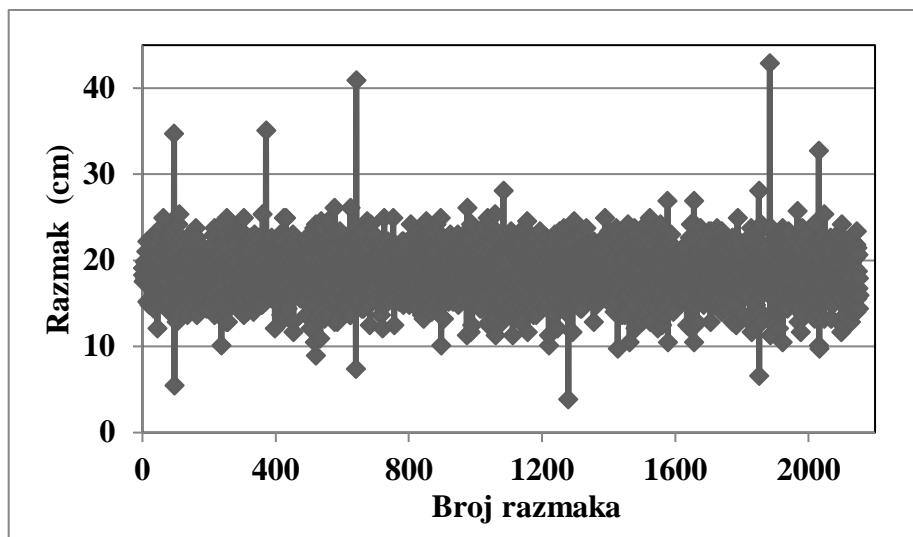
Slika 12. Ostvareni razmaci pri laboratorijskoj simulaciji sjetve kod sijačice PSK OLT-
