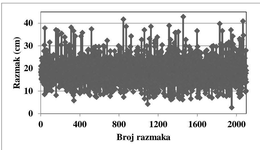
Slika 13. Ostvareni razmaci pri laboratorijskoj simulaciji sjetve kod sijačice PSK OLT-
