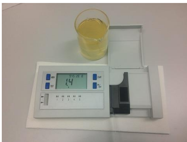
Slika 8. Uređaj za mjerenje HMF-a
