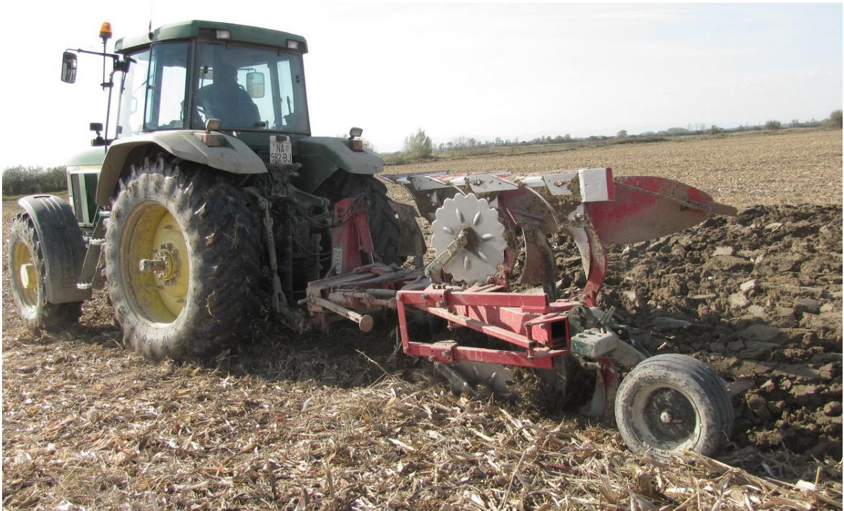
Slika 1. Konvencionalna obrada tla oranjem (izvor: Jug, D.)
