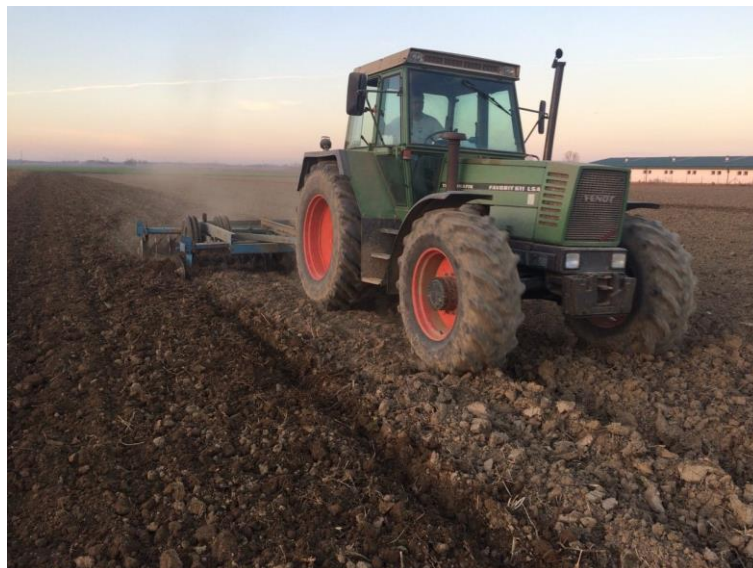
Slika 2. Predsjetvena priprema tla tanjuranjem (izvor: Tokić, M.)
