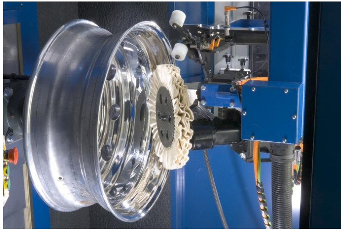
Slika 6. Postupak poliranja aluminijevskih legura
