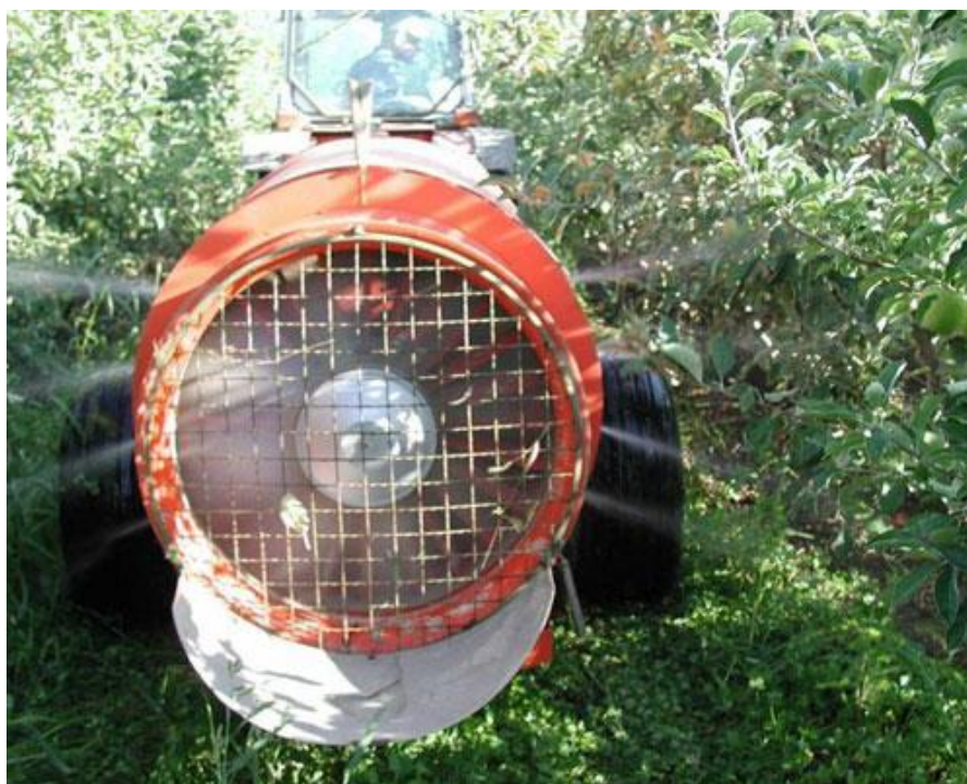
Slika 5. Mogućnost korištenja standardne opreme za primjenu pesticida pri primjeni entomopatogenih nematoda
