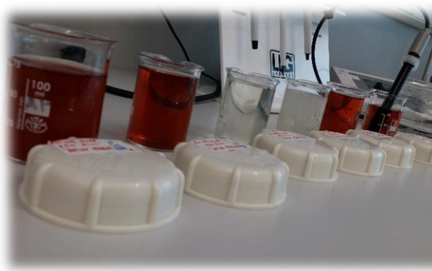
Slika 23. Vizualizacija i mjerenje pH tekućeg medija na TIB sustavu (Foto: Bošnjak, 2018.)
