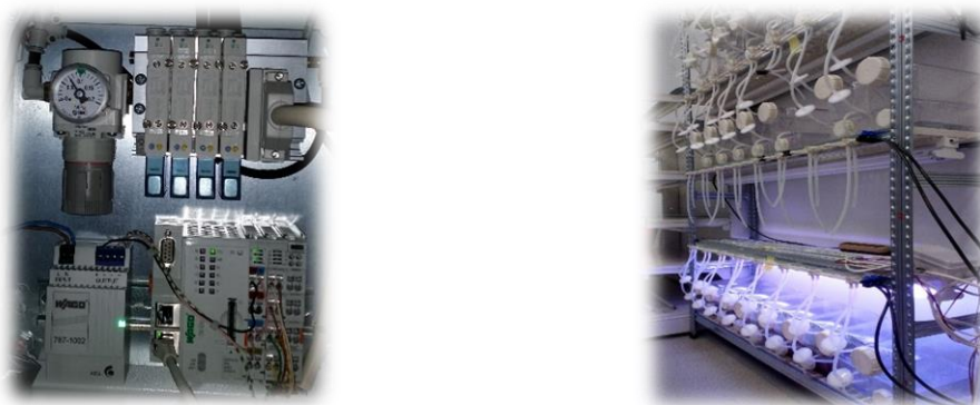
Slika 15. TIB sustav na Fakultetu agrobiotehničkih znanosti Osijek – Katedra za voćarstvo, vinogradarstvo i vinarstvo – lijevo kontrolna jedinica, desno TIB sustav bioreaktora (Foto: Bošnjak, 2018.)
