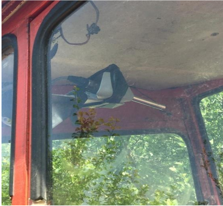
Slika 8. Zvučna sonda postavljena na desnoj strani traktora
