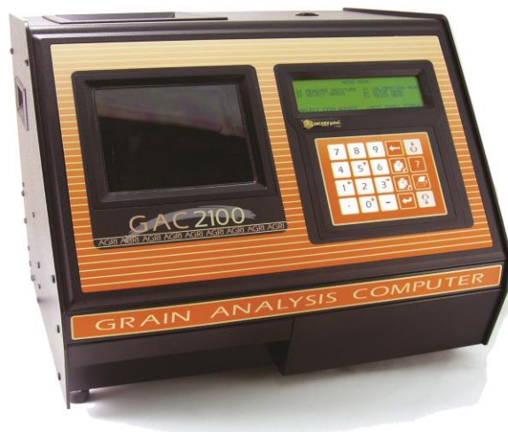
Slika 6. Električni vlagomjer ( http://www.dickey-john.com/product/gac-2100-agri/ )
