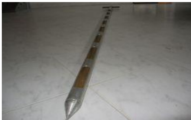
Slika 5. Izuzimač uzoraka ( http://www.santimdoo.rs/sonde/007.jpg )
