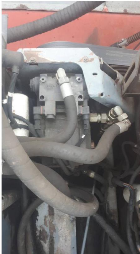
Slika 13. Prikaz pogonske hidro crpke kombajna „MF Cerea 7274“ Izvor: Nikola Papac
