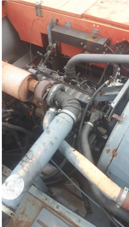
Slika 12. Prikaz motora „SISU VALMET“ kombajna „MF Cerea 7274“ Izvor: Nikola Papac
