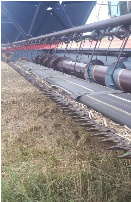
Slika 3. Prikaz žetelice kombajna s uvlačnim trakama kombajna „ MF Cerea 7274 “ Izvor: Nikola Papac
