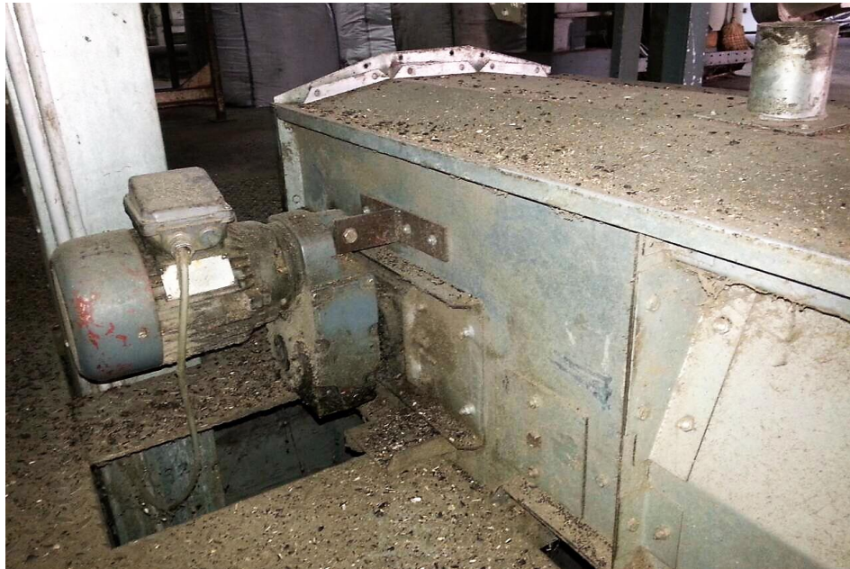
Slika 27. Pogonski motor na trakastom transporteru (Fotografija: Đurkić, 2018.)
