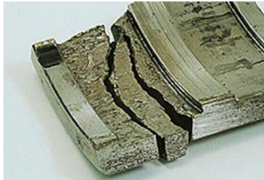
Slika 22. Primjer pukotine kotrljajućeg ležaja
