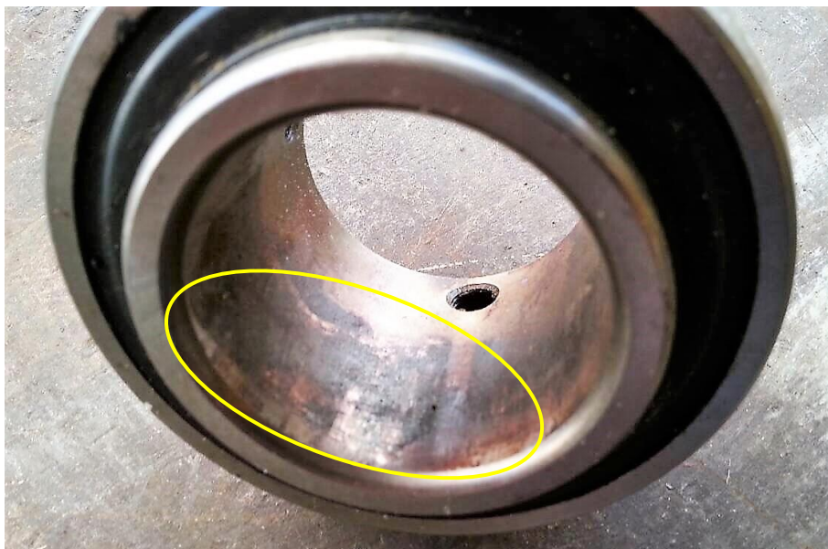
Slika 43. Korozijsko trošenje unutarnjeg prstena ležaja (Fotografija: Đurkić, 2018.)
