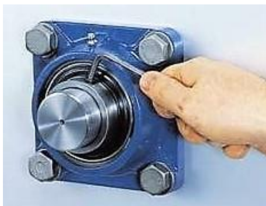
Slika 33. Zatezanje vijka na unutarnjem prstenu Y-ležaja
