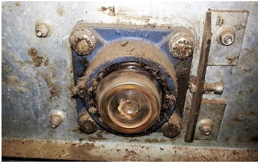
Slika 34. Jedinica Y-ležaja trakastog transportera u radu (Fotografija: Đurkić, 2018.)
