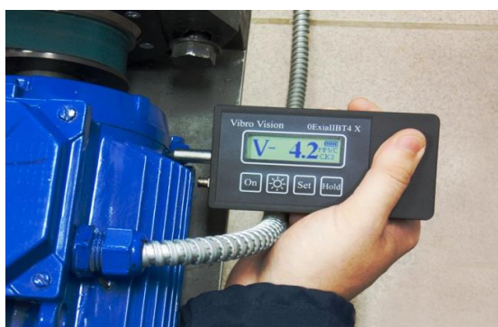
Slika 24. Mjerenje vibracija pomoću vibrometra (Izvor: http://vibrocenter.com/vibrovision_e.htm )
