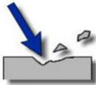
Slika 12. Erozijsko trošenje (Izvor: Žnidarec, 2009.)
