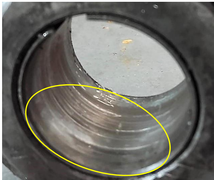
Slika 39. Abrazijsko trošenje unutarnjeg prstena ležaja (Fotografija: Đurkić, 2018.)
