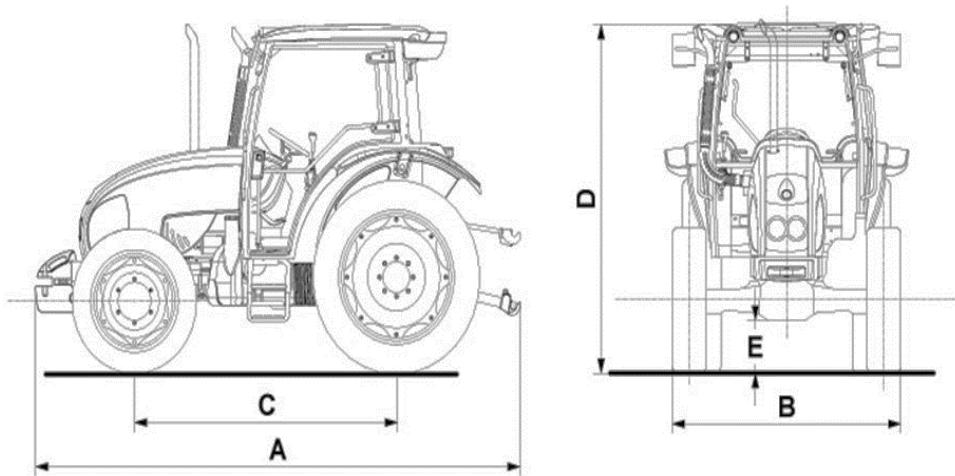
Slika 3. Prikaz dimenzija traktora Landini Powerfarm DT100
