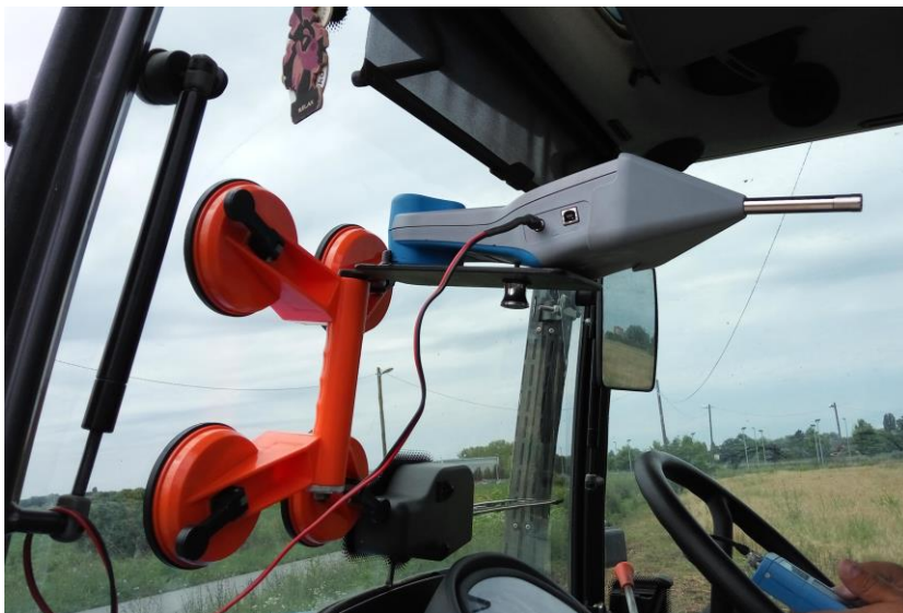
Slika 5. Položaj uređaja za mjerenja buke Metrel Multinorm MI 6201 EU u odnosu na referentnu točku sjedala rukovatelja
