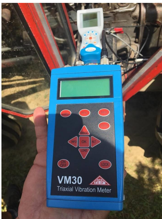
Slika 3: Uređaj za mjerenje mehaničkih vibracijaMMF VM30-H
