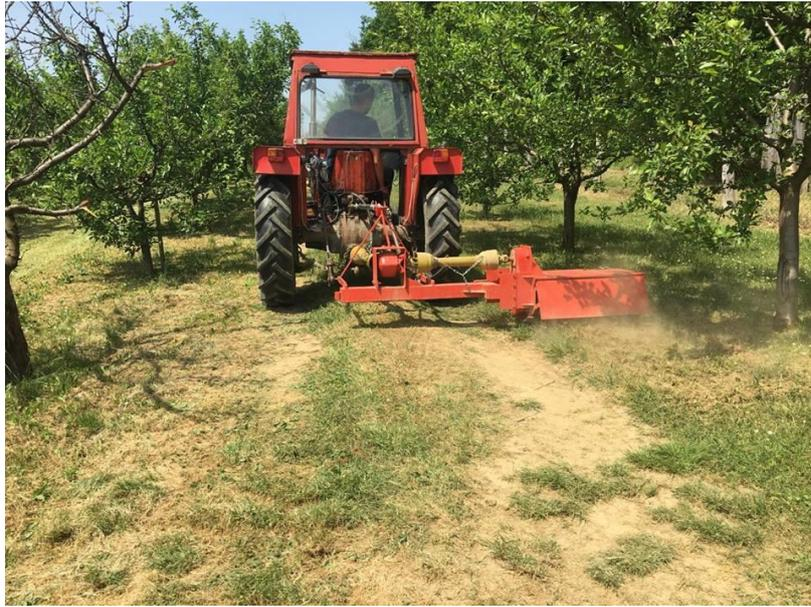
Slika 6: Bočna freza
