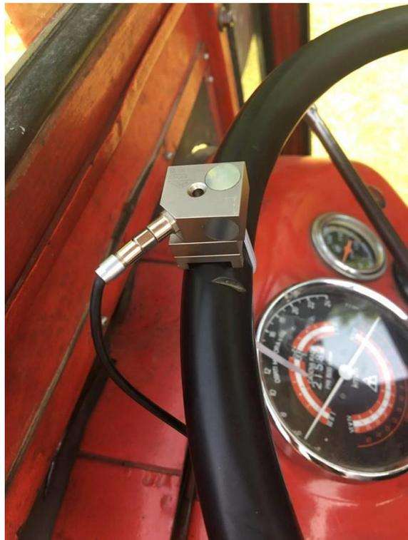
Slika 11: Senzor za vibracije
