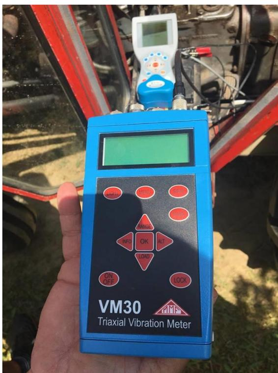
Slika 3: Uređaj za mjerenje mehaničkih vibracija MMF VM30-H
