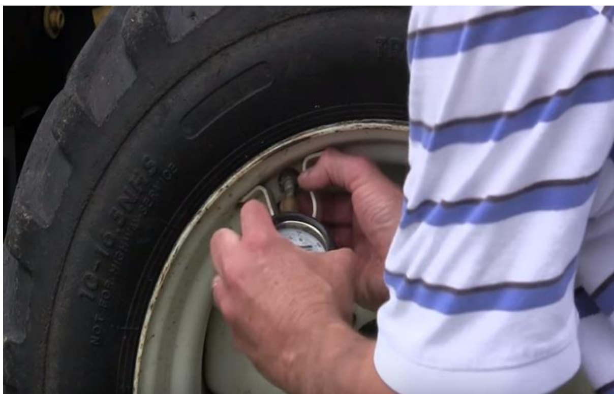
Slika 9. Provjera tlaka u pneumaticima (Izvor: Vlastita fotografija.)
