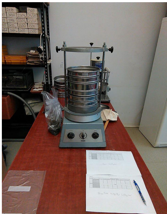
Slika 14. Električni uređaj za prosijavanje tla (Izvor: Vlastita fotografija)
