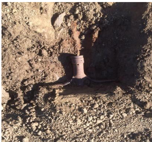
Slika 11. Uzimanje uzorka tla (Izvor: Vlastita fotografija)
