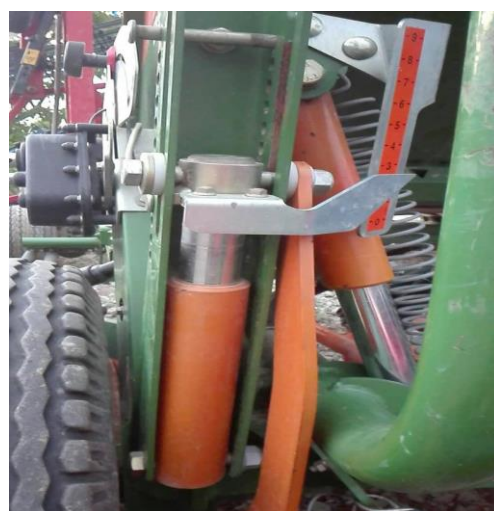
Slika 9. Hidraulični cilindar za potisak na ulagače
