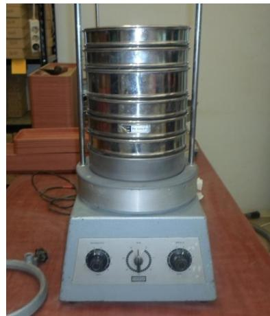
Slika 24. Električni uređaj „RHEWUM“ za prosijavanje tla
