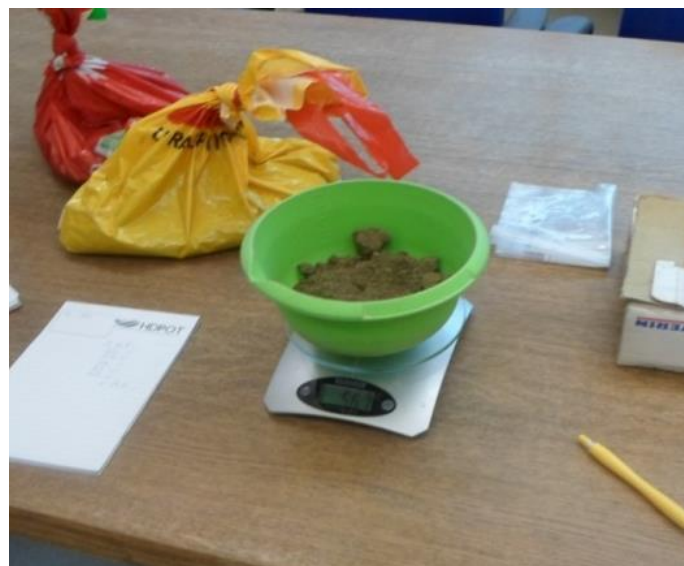
Slika 23. Vaganje uzorka prije prosijavanja (Izvor: Vlastita fotografija)
