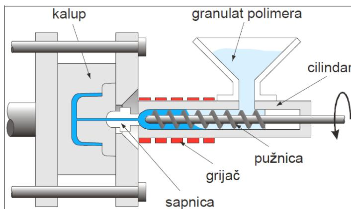
Slika 31. Shema postupka injekcijskog prešanja (Izvor: Rakonić, 2013.)
