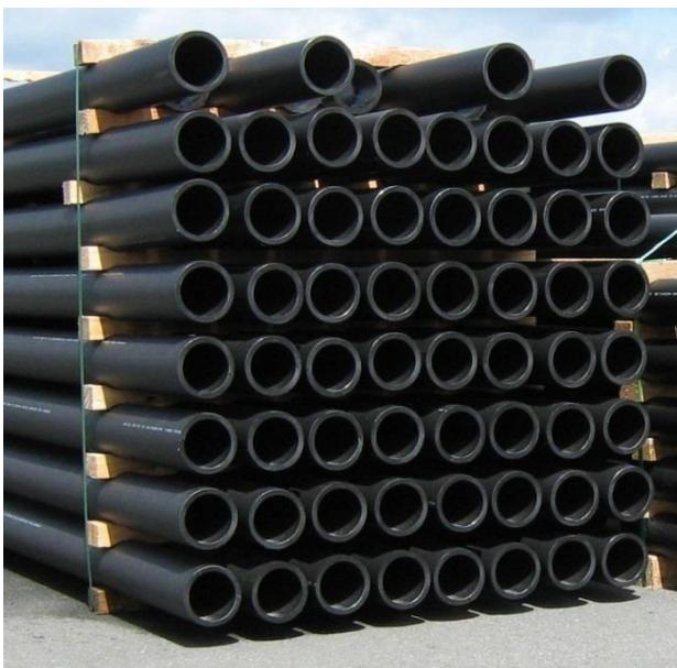
Slika 11. Cijevi od PE-100 materijala u drvenim okvirima
