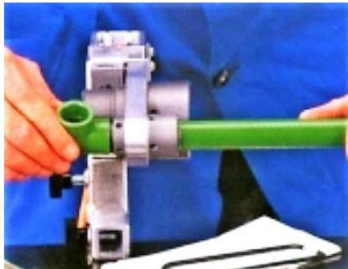
Slika 23. Zavarivanje PP-R cijevi: Zagrijavanje cijevi i koljena
