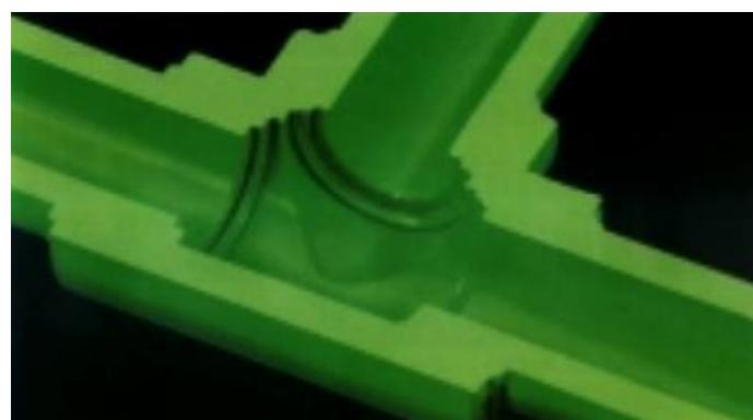
Slika 22. Dobro izvedeni spoj PP-R cijevi s račvanjem
