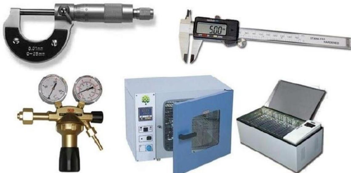
Slika 15. Oprema za ispitivanje polietilenskih cijevi za vodu (Izvor: Gabud, 2016.).
