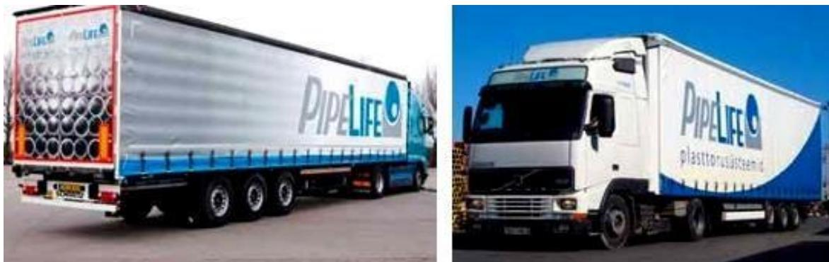
Slika 12. Transport PE cijevi
