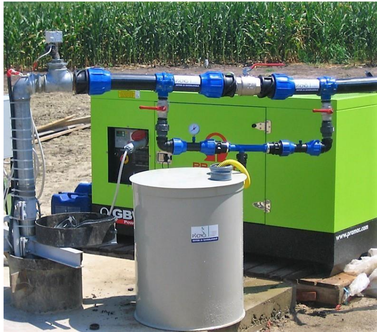
Slika 28. Dijelovi sustava za navodnjavanje od PVC-a (Izvor: http://pseno.hr/navodnjavanje/oprema-za-navodnjavanje/ )
