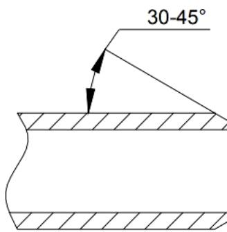
Slika 20. Obrada krajeva PP-R cijevi (Izvor: <http://kalinic.info/strucni/cijevi.pdf>)
