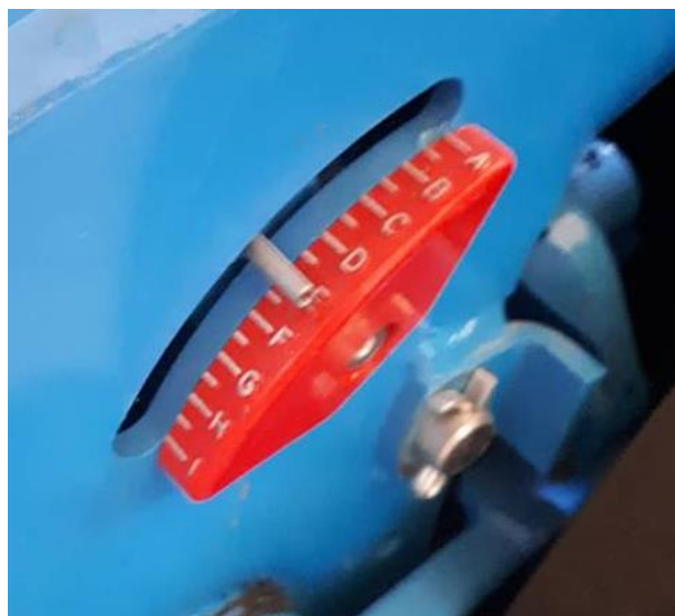
Slika 7. Indeks podešenosti dubine sjetve (Izvor: Vlatko Gojević)
