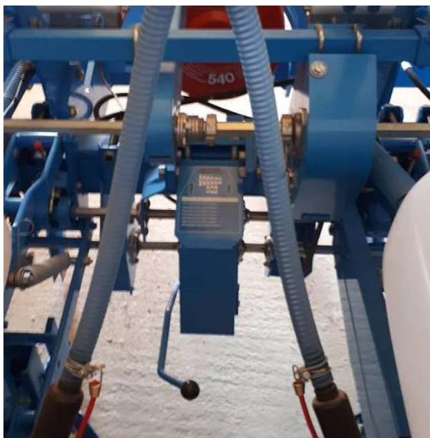
Slika 8. Glavni mjenjač sjetve (Izvor: Vlatko Gojević)
