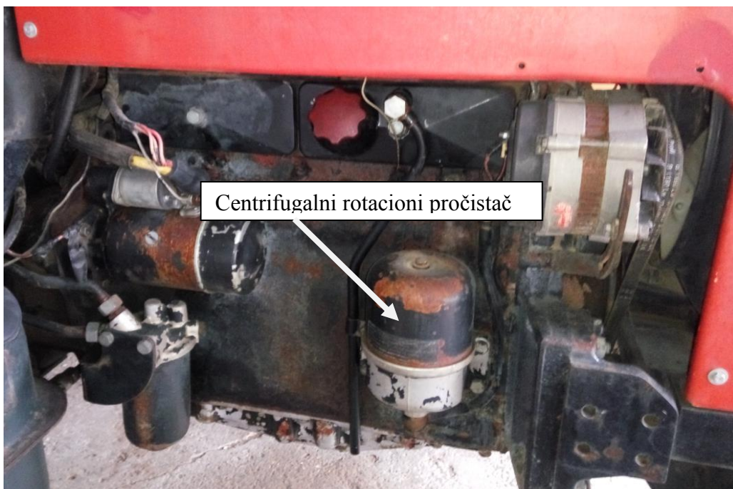
Slika 28. Centrifugalni rotacioni pročistač ulja (izvor: autor)
