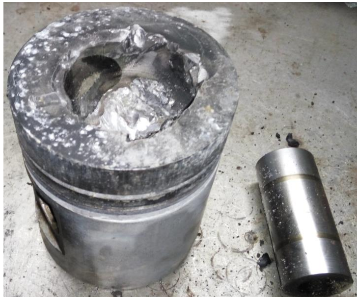
Slika 20. Oštećen klip i osovinica klipa (izvor: autor)
