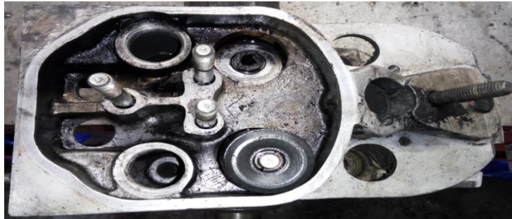
Slika18. Oštećena cilindarska glava (izvor: autor)
