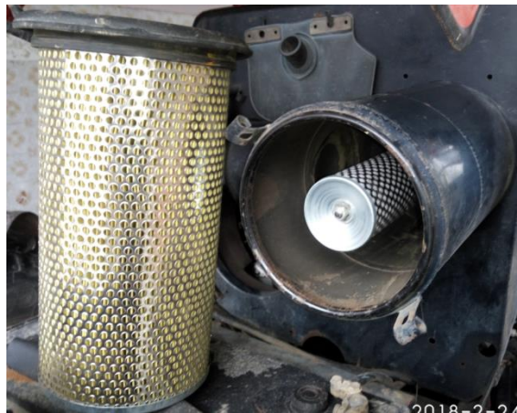
Slika 12. Grubi i fini suhi pročistač (izvor: autor)
