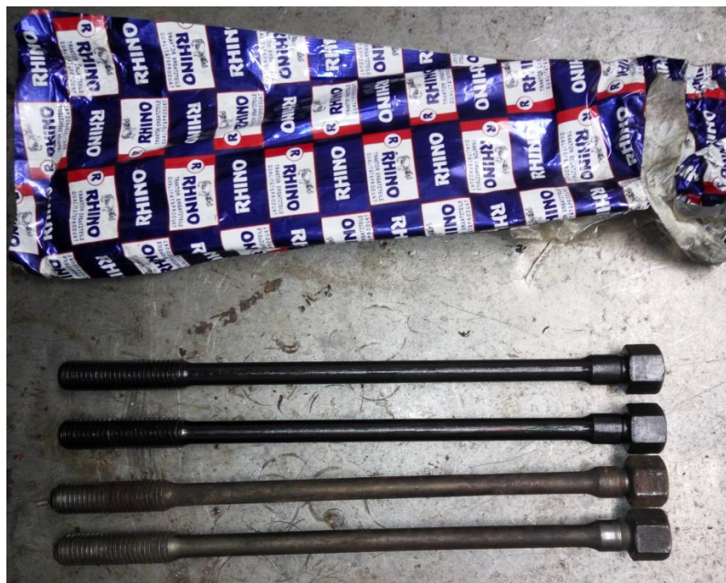
Slika 17. Elastični vijci cilindarske glave (izvor: autor)
