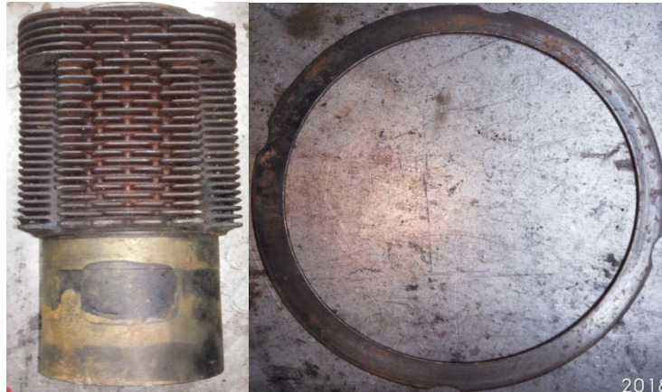
Slika 21. Cilindar i klipni prsten cilindarske glave (izvor: autor)
