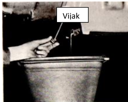
Slika 2. Izmjena ulja u motoru
