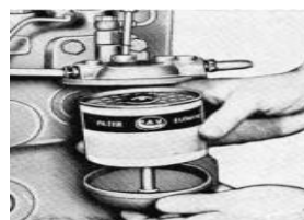
Slika 36. Sastavljanje pročistača goriva
