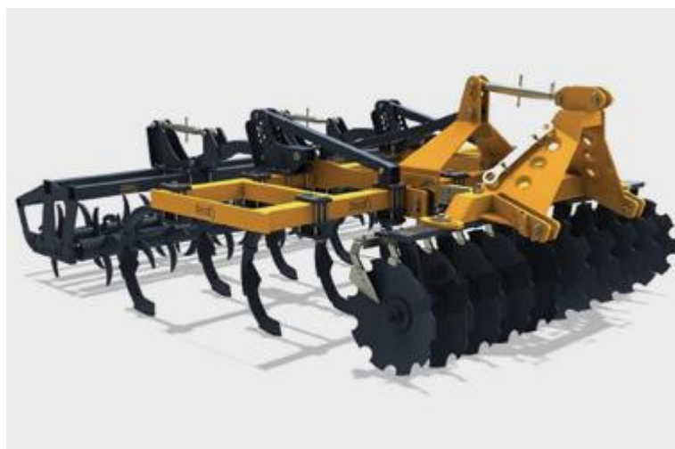
Slika 9. Primjer kombiniranog oruđa za predsjetvenu pripremu tla
